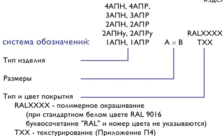
Пример обозначения при заказе диффузора 2АПР 450 x 450, цвета RAL1015:
