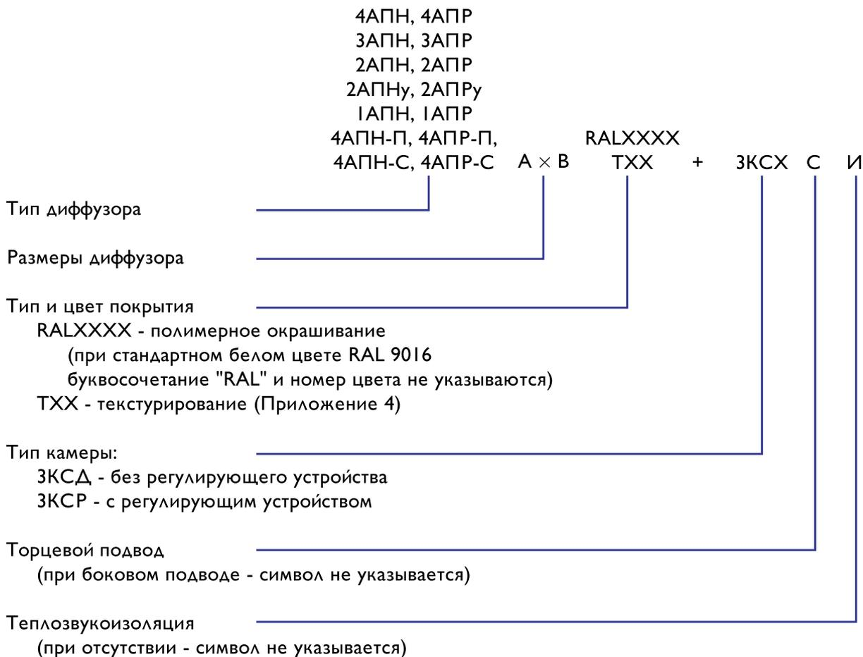
Пример обозначения при заказе диффузора 4АПР размером 600 x 600 мм (фактический размер диффузора составляет 595 x 595 мм) белого цвета RAL 9016 с камерой статического давления с боковым подводом без регулирующего устройства, без теплозвукоизоляции:
