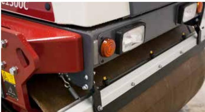
Держатель очистного скребка совмещен с рампой для подачи воды. Три водяные форсунки обеспечивают равномерное смачивание поверхности вальца. Интервальный таймер орошения является стандартным оснащением катка
