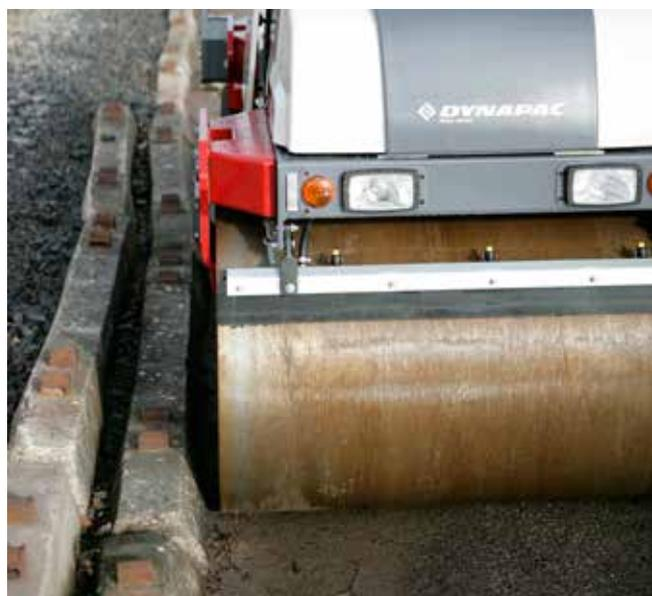
Большая высота под боковыми опорами вальцов позволяет работать вплотную даже рядом с высокими бордюрами. Отличная обзорность боковых кромок вальцов обеспечивает полный контроль за работой катка и высокое качество уплотнения.
