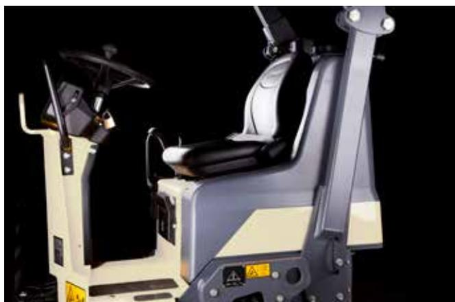
Просторная рабочая платформа обладает улучшенной виброизоляцией, имеет комфортное кресло оператора. Опциональная дублированная рукоятка хода обеспечивает дополнительное удобство при эксплуатации.
