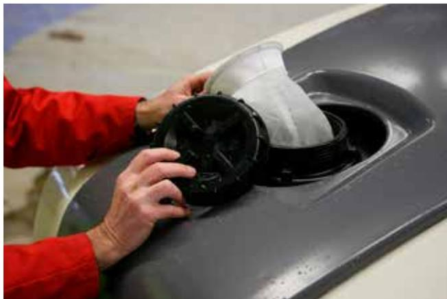
Водяной бак имеет увеличенный до 200 литров объем и большую, удобно расположенную заправочную горловину
