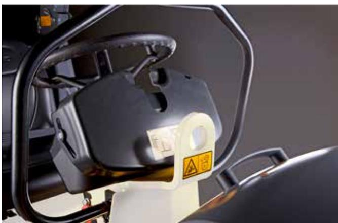
Прочная и крепкая центральная грузоподъемная проушина упрощает погрузку и разгрузку катка.
