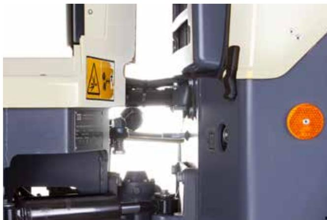
Увеличенные сервисные интервалы и не требующие обслуживания рулевой шарнир и рулевой гидроцилиндр способствуют снижению объема технического обслуживания.
