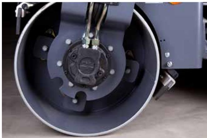
Вальцы увеличенного диаметра делают процесс уплотнения простым, даже на мягких типах смесей без риска повреждения покрытия.
