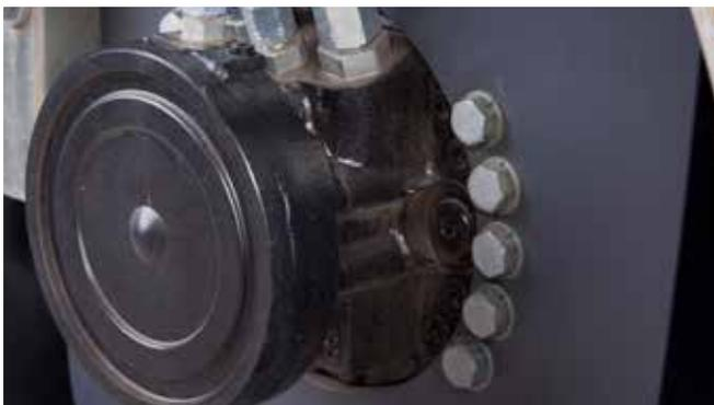
Отказоустойчивые тормоза на обоих вальцах (или на вальце и колёсах у комби версий) автоматически активируются при остановке двигателя или возникновении неисправности.
