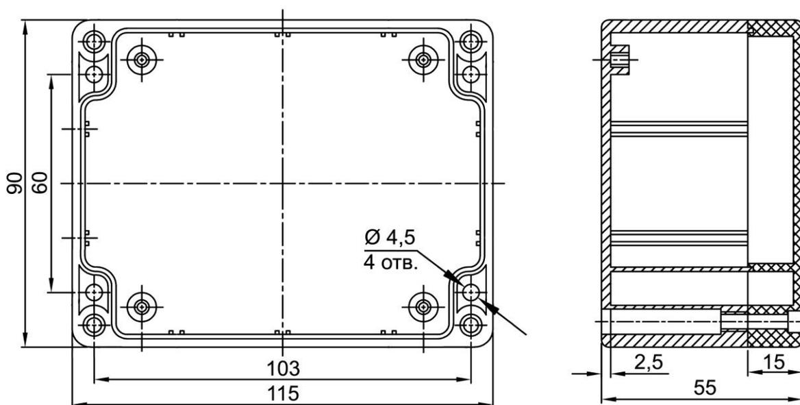
Рис. 3. Размеры монтажного бокса и расположение крепежных отверстий
