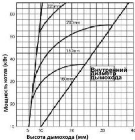
Самый высокий уровень дымохода снаружи должен соответствовать размерам, приведенным на следующей схеме таким образом, чтобы минимизировать вредное воздействие продуктов сгорания на окружающую среду и для улучшения тяги в дымоходе.
