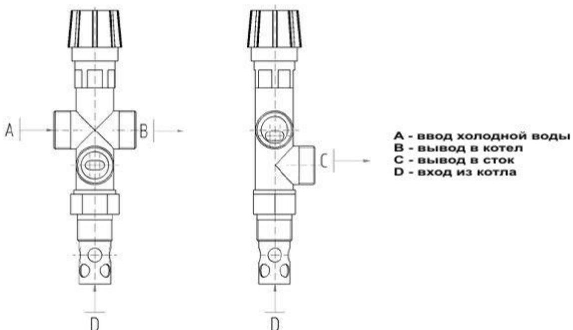
Рис. 4 Двухходовой предохранительный вентиль DVB 1 - 02
