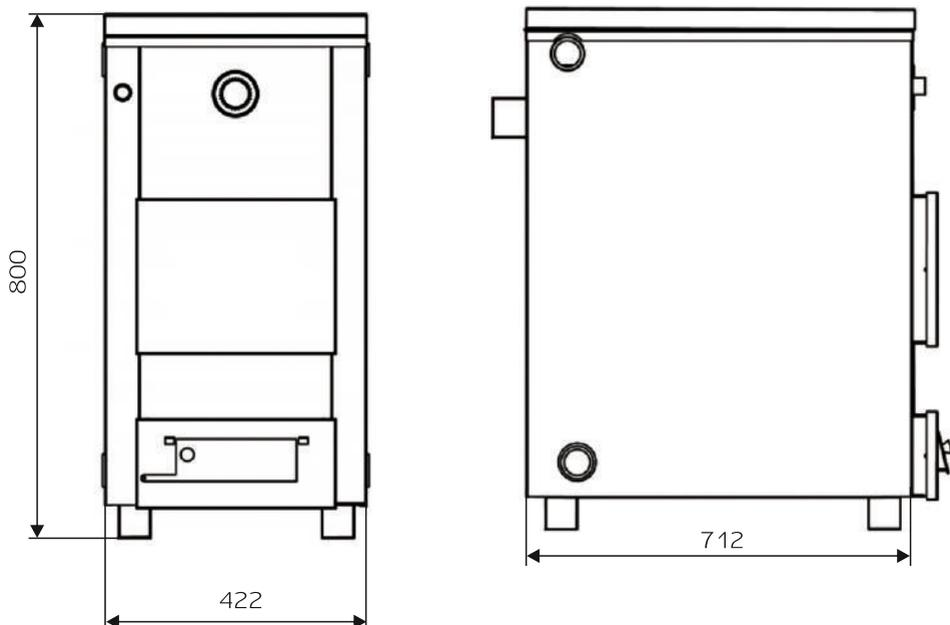
Рис. 3 Габаритные размеры котла «Сибирь-Гефест» 20 кВт
