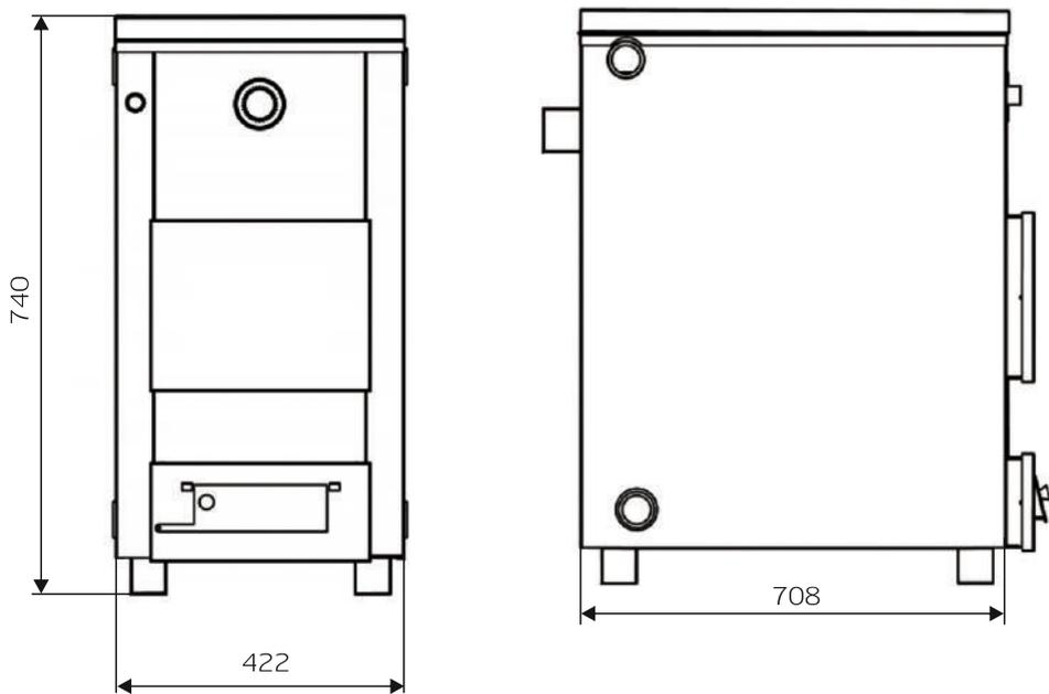
Рис. 2 Габаритные размеры котла «Сибирь-Гефест» 15 кВт
