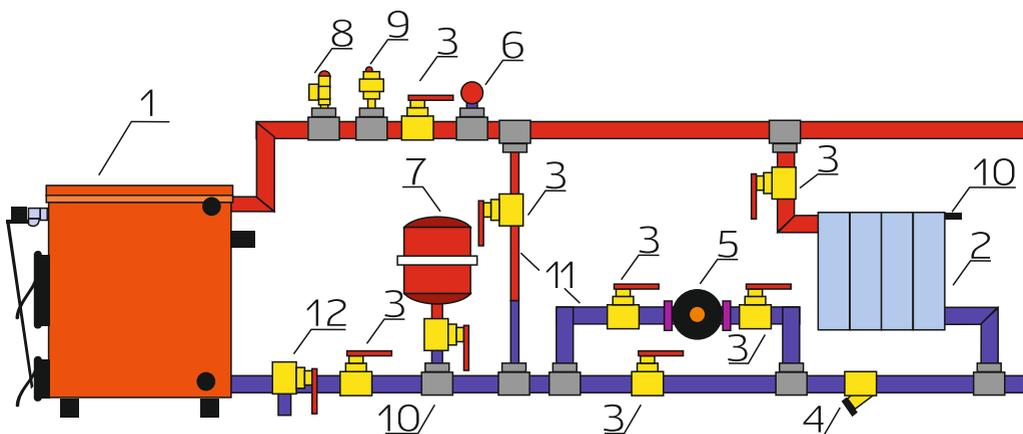
Подключения котла к **двухтрубной закрытой системе** с принудительной циркуляцией теплоносителя:
