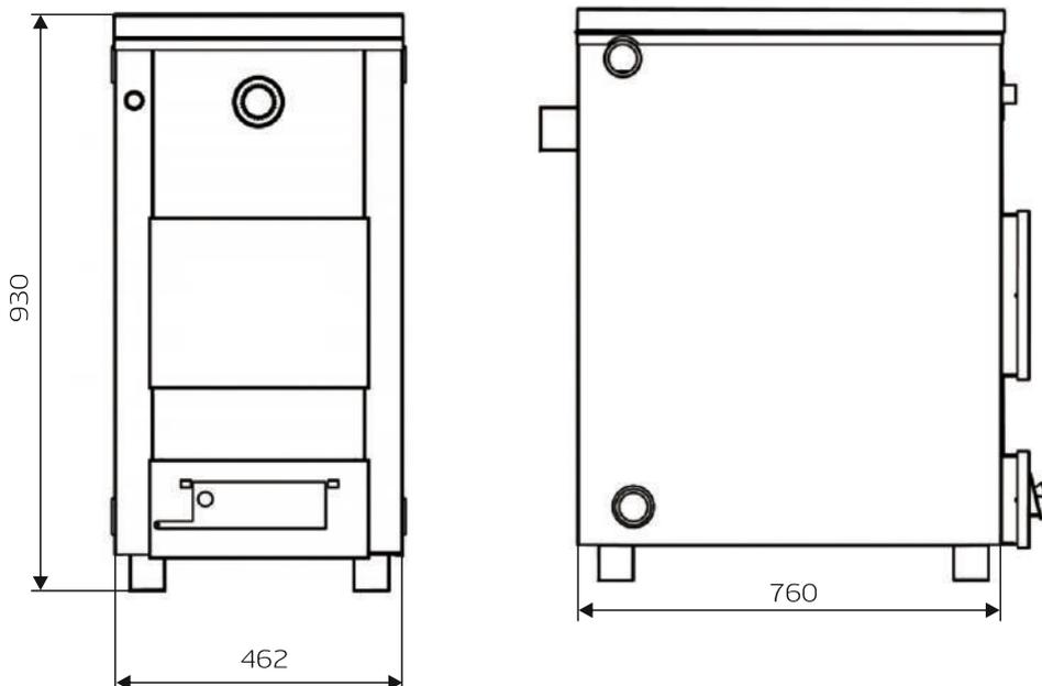
Рис. 4 Габаритные размеры котла «Сибирь-Гефест» 30 кВт
