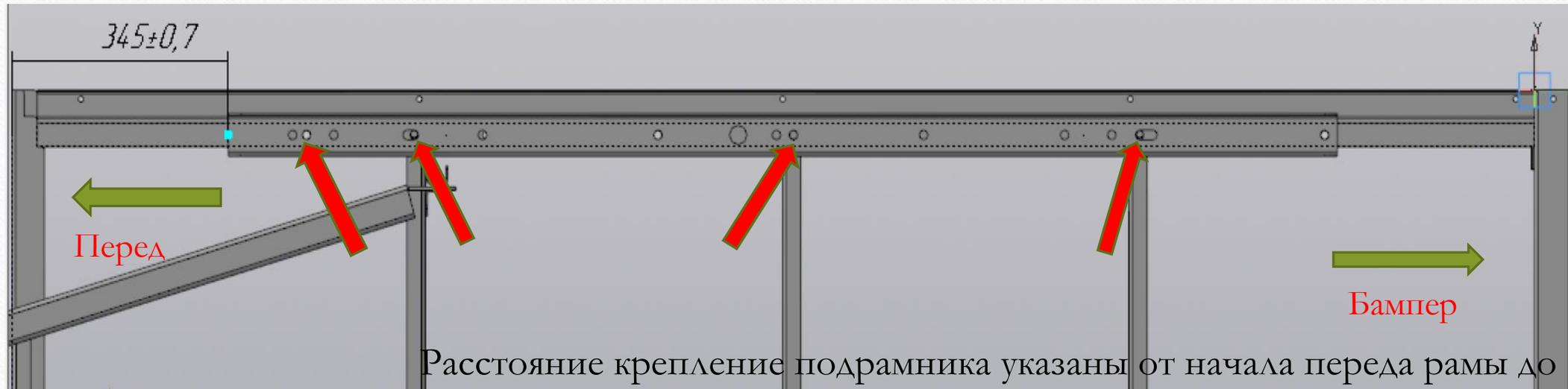
Расстояние крепление подрамника указаны от начала передрамы до начала подрамника.
