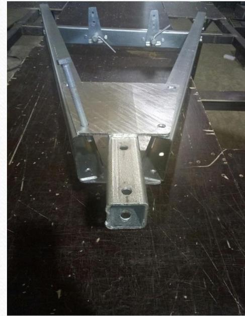
Это пример для сборки водила, дальше фото сборки перемычки водила для самосвала, а так же крепления к раме прицепа
