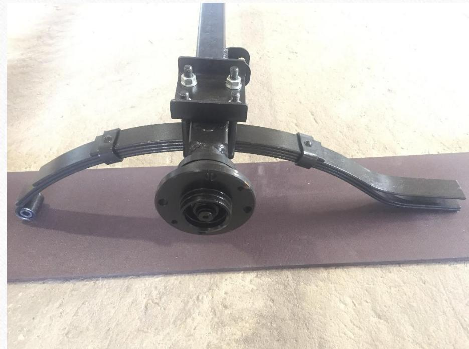
Таким образом устанавливается рессора на раме прицепа. На фото справа показан «каблучок» в который вставляется рессора. Перед установкой обильно смазать смазкой «Литол» внутреннею поверхность «коблучка», где происходит трение. Продолжаем сборку по аналогичной схеме и с другой стороны, при этом ничего не затягиваем до упора. Только при полной установки подвески производим затяжку болтовых соединений.
