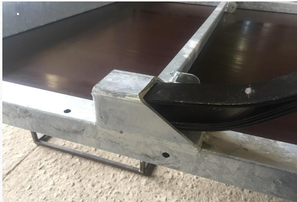
Волговская рессора устанавливается аналогичным способом. В Задней части рамы прицепа и рессоры устанавливаются Серьги (оцинкованные пластины с отверстиями), по 2 штуки с каждой стороны. Смотрите фото ниже.
