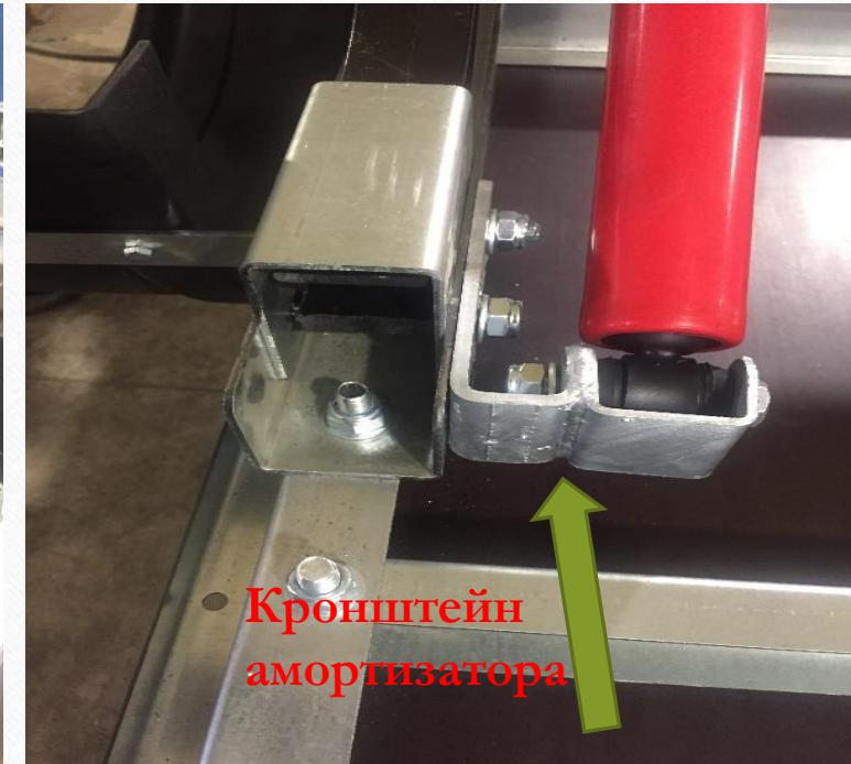
Передняя часть рессоры устанавливается в подрамник с проставкой оцинкованными шайбами М 12 увеличенными в кол-ве двух штук. Не забываем одновременно крепить передний кронштейн крыла. Смотреть на фото.
