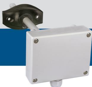
DSTHX-2 - это каналный датчик, который измеряет температуру и относительную влажность. Он имеет широкий диапазон низковольтного питания и два аналоговых / модулирующих выхода. Все параметры доступны через Modbus RTU.
