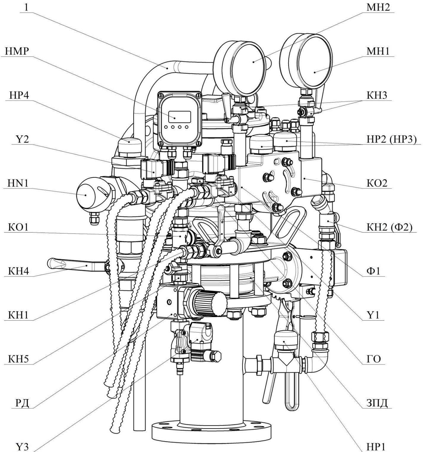
Рисунок 3 – Общий вид КПУУ «Спринт»
