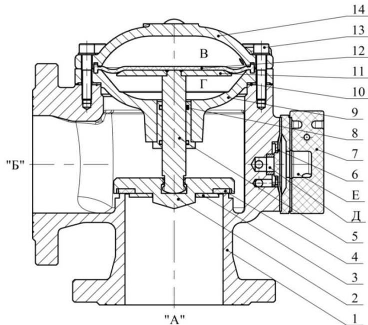
Рисунок 1 - Клапан мембранный универсальный КСД типа КМУ
