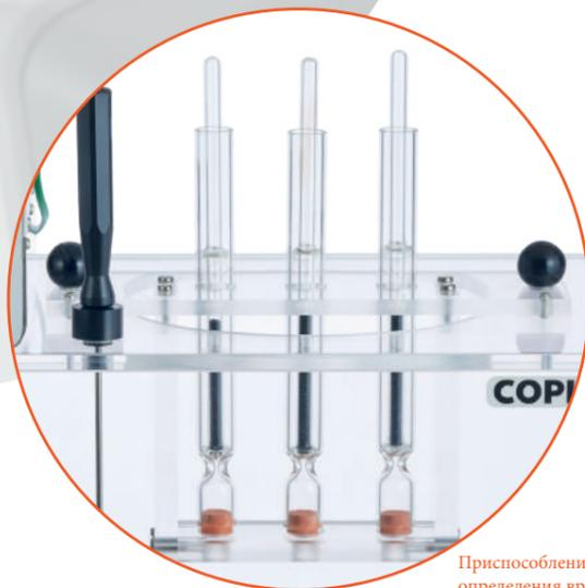
Приспособление для определения времени деформации
