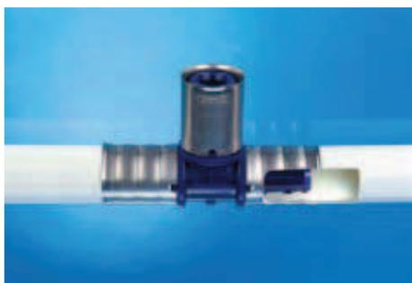
Корпус соединителя выполнен из полифенилсульфона (ПФС). Это современный высокотехнологичный материал, сравнимый по прочности с металлом. Пресс-гильза, выполненная из нержавеющей стали, служит для удержания трубы на штуцере соединителя. В основании пресс-гильзы имеются окна для контроля полной вставки трубы в соединитель в процессе монтажа. Уплотнительные кольца изготовлены из современного эластомерного материала, они обладают высокой температурной стойкостью и обеспечивают 100% герметизацию.
