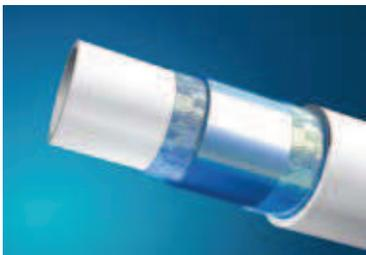
Труба TIGRIS ALUPEX белого цвета состоит из алюминиевой фольги, внутреннего PE-Xc и наружного PE слоев. Все слои между собой соединены клеем, в результате получается пятислойная труба. Сварка фольги выполнена лазером "встык". Это обеспечивает монолитность трубы, придает ей 100% кислородонепроницаемость, высокую формостабильность и минимальное температурное удлинение. Метод сшивки PE-Xc очень гигиеничен, химические соединения при сшивке не используются, побочным продуктом является водород.
