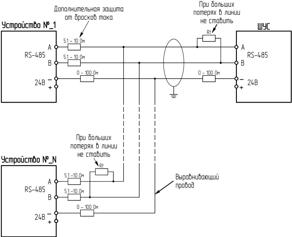
Для стабильной работы приборов в сети RS-485, необходимо наличие третьего (выравнивающего) провода, соединяющего «нули» приборов (обычно это минус питания прибора или специальная клемма).
