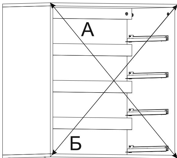
8. Наложите на заднюю сторону комода два ДВП 9, установив между ними соединительный профиль 26. Гвоздями 2x20 прибейте задние стенки, контролируя размеры диагоналей А и Б.
