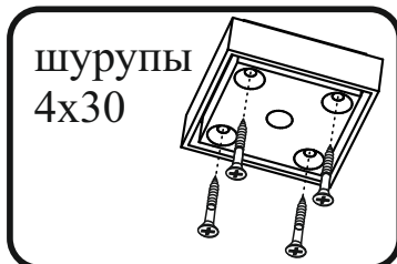
схема монтажа опоры
