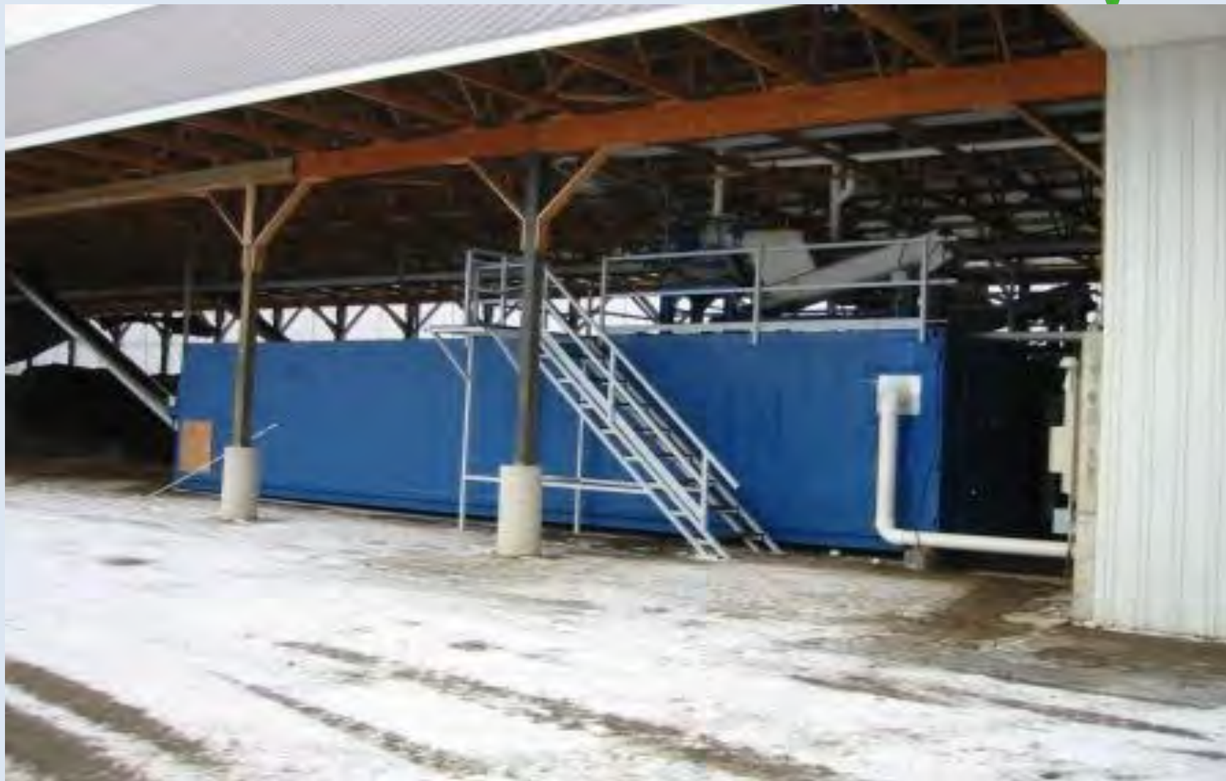
Фильтрационно-сушильная установка - ФСУ.
