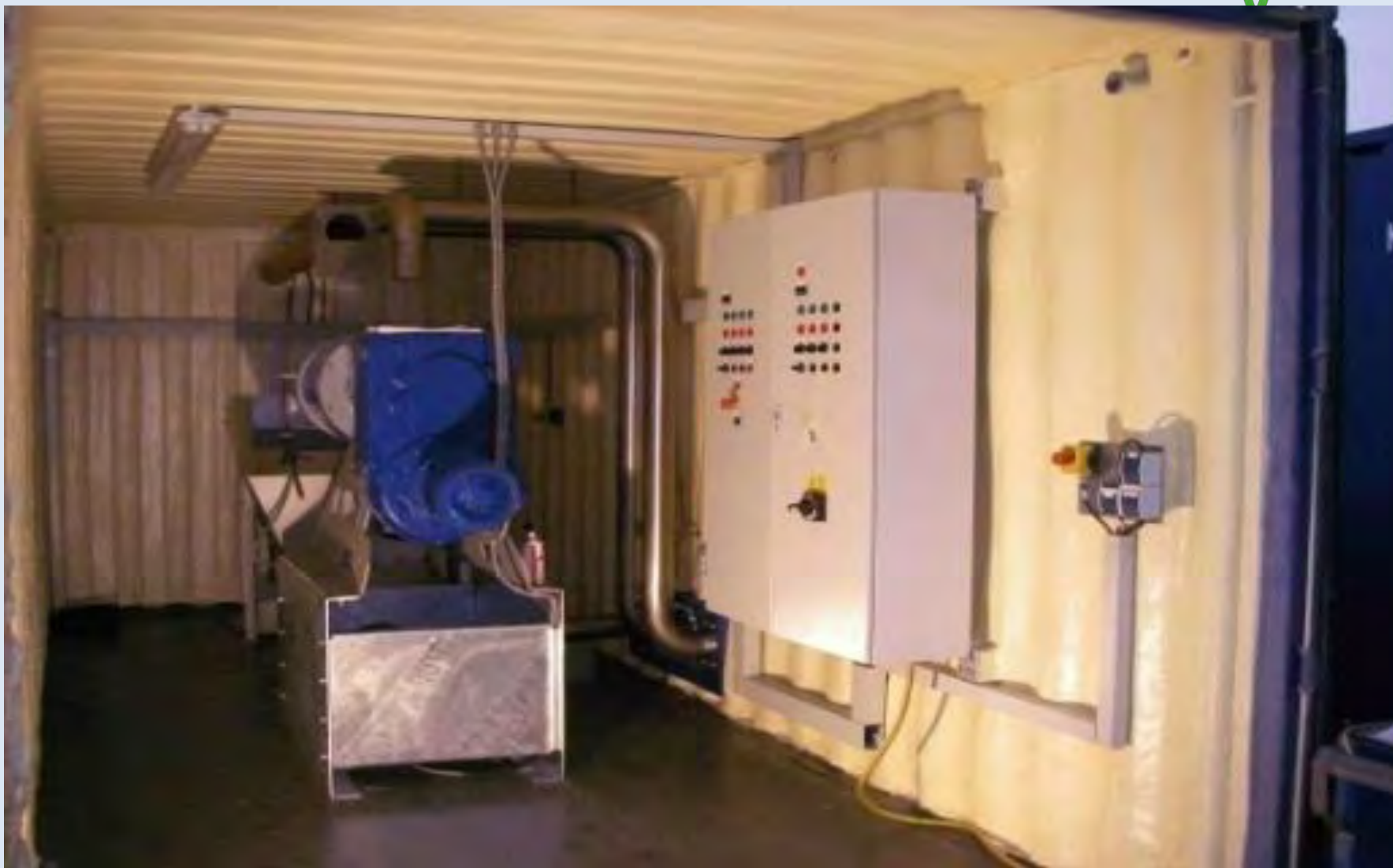
Пульт управления с сепаратором ФСУ.
