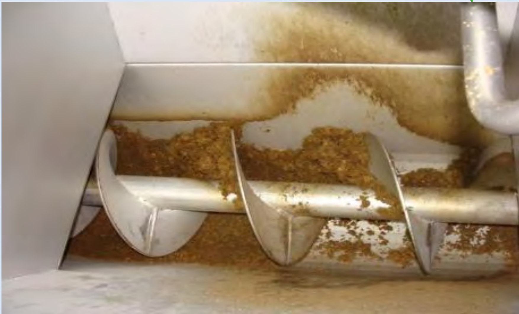
Подача отсепарированного навоза от сепаратора на барабан ФСУ.
