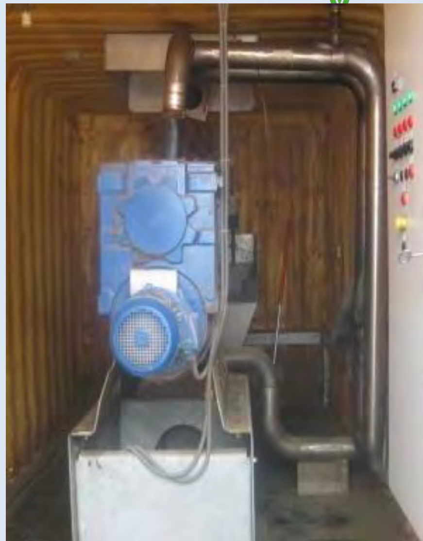
Фильтрационно-сушильная установка - ФСУ.
