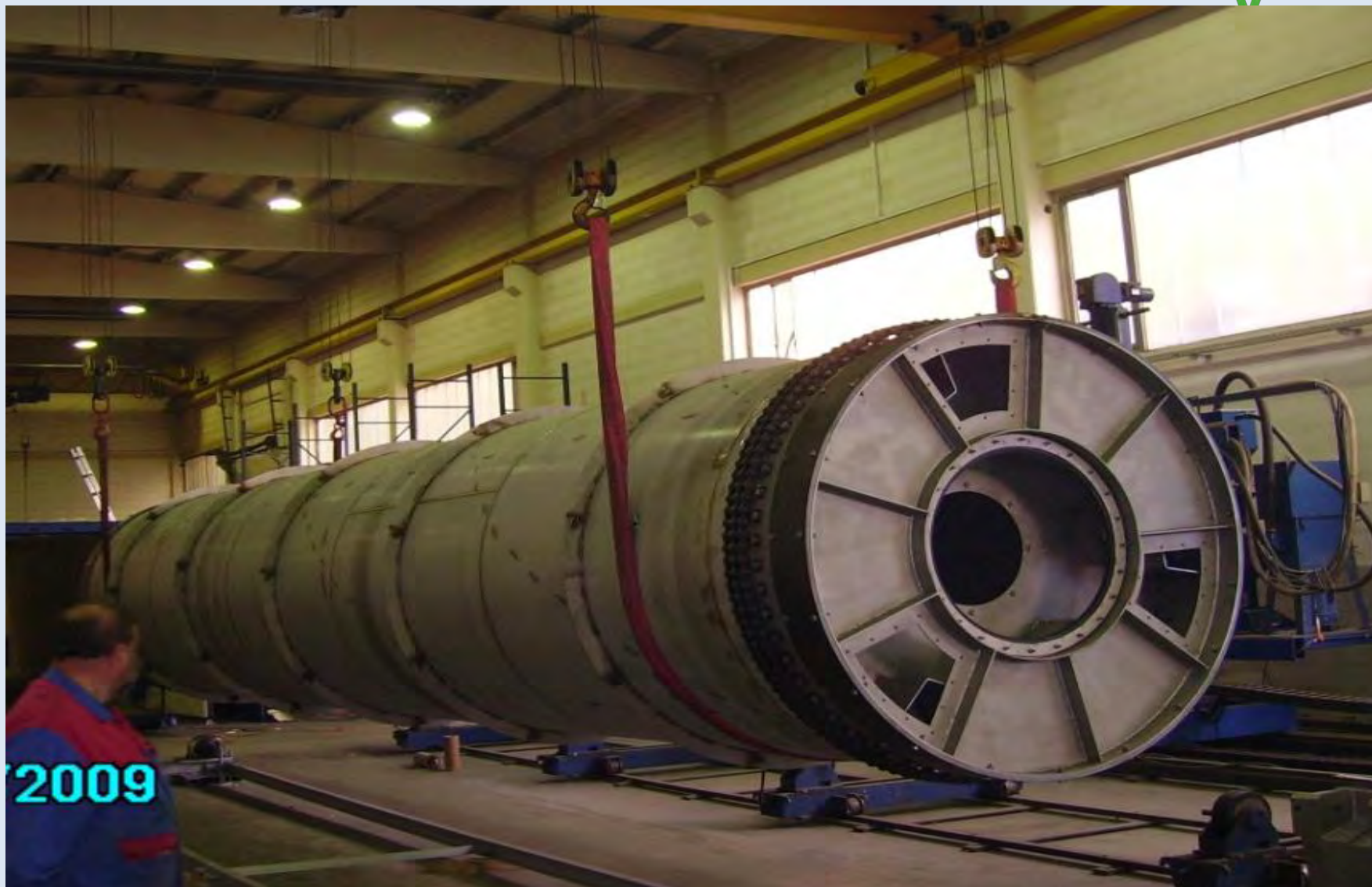
Барабан ФСУ при монтаже на заводе.
