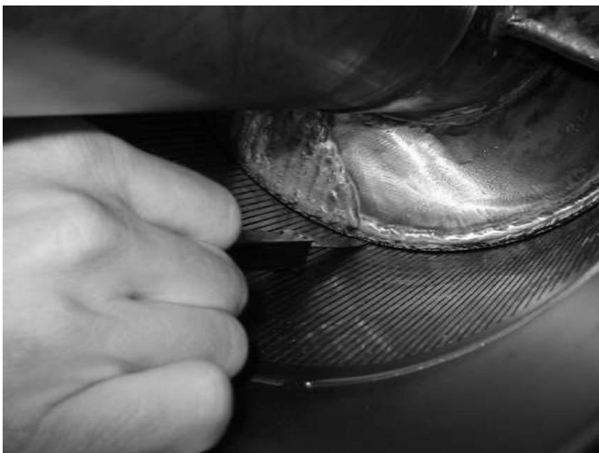
Рис. 6-12 Измерение рабочего зазора между ситом и шнеком
