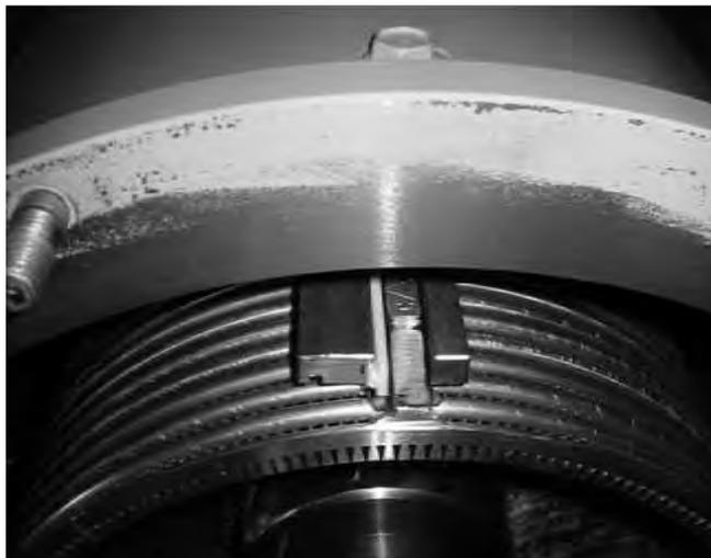
Рис. 6-7 Установочное положение сита, отштампованный треугольник сверху и вперед по направлению к сепаратору
