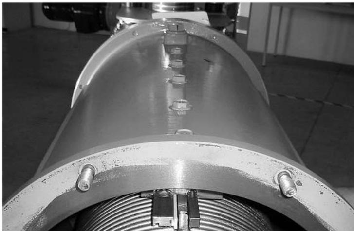
Рис. 6-5 Положение фиксирующих болтов для направляющих шин сита
