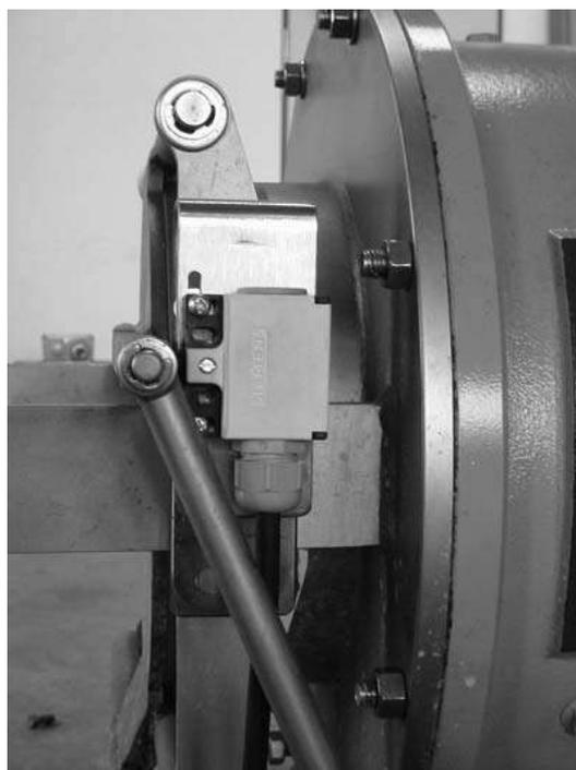
Рис. 4-3 Концевой выключатель для страховки от прорыва пробки
