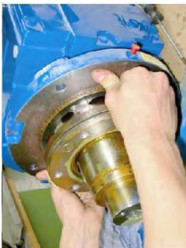
Рис. 8-4 После нажатия длинными болтами в резьбовые отверстия съемной крышки вынуть держатель сальника
