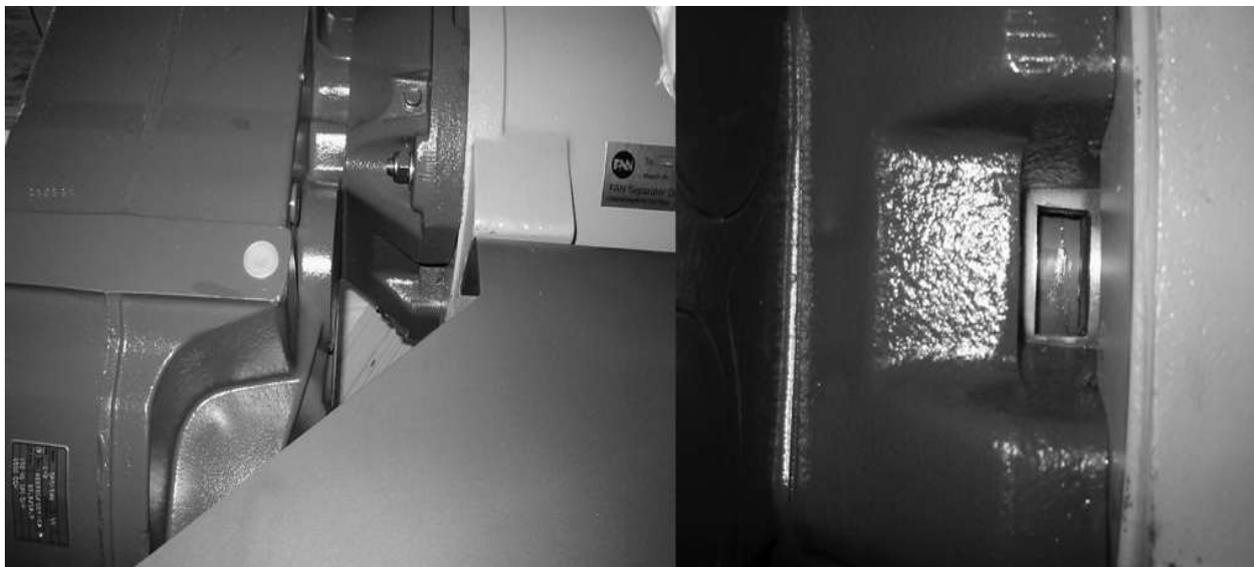
Рис. 8-1 Осмотр контрольного отверстия для проверки исправности сальника
