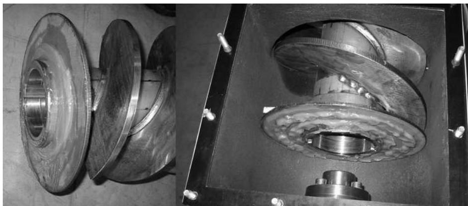
Рис. 6-10 Шнек с концевым диском
