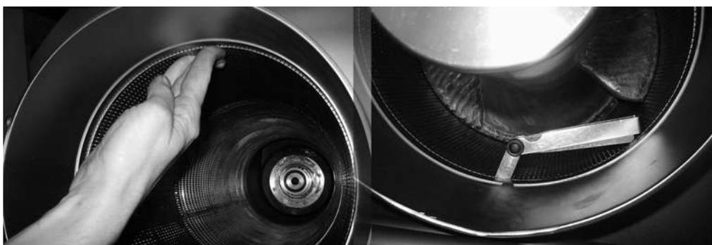
Рис. 6-8 Подвижное сито в корпусе сепаратора
