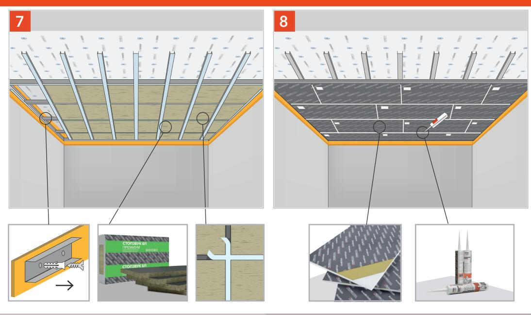
Наклеиваем демпферную ленту на поверхность профиля, заполняем пространство плитами СтопЗвук БП. Удаляем дюбеля из профиля ПН.
