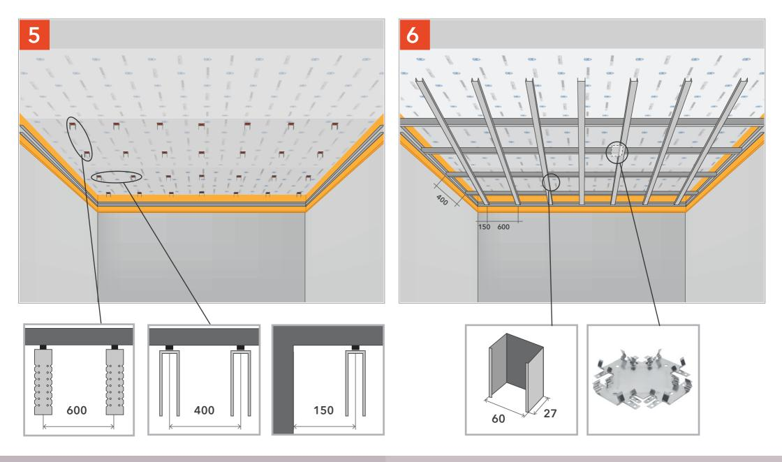
Крепим Виброподвесы Сонокреп с шагом 400 поперек и 600 вдоль комнаты. Ближайший к стене должен быть на расстоянии 150 мм. Крепим профиль ПП к виброподвесам и связываем между собой с помощью профиля соединительного (Краб).
