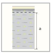
Оклеиваем лентой СтопЗвук V100 периметр стены с помощью виброакустического герметика Сонетик или клея Баутгер.
