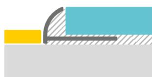
**Описание товара:** Перфорированный скругленный профиль для криволинейной отделки наружных углов, подходит для гибочника.
