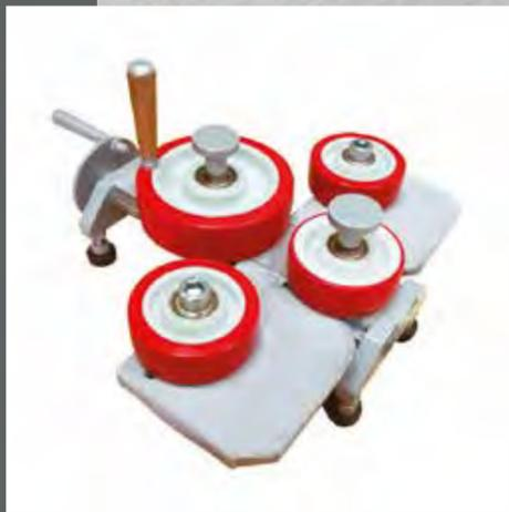
Для работ с перфорированными профилями для криволинейных стыков вы можете приобрести или взять у нас в аренду специальный станок.
