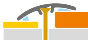
**Описание товара:** Порог из анодированного алюминия или латуни шириной 30 мм. Имеет продольную жесткость. Применяется для соединения стыков между плиткой, ламинатом, паркетом, ковровыми покрытиями имеющими перепад до 8 мм. Самоклеющаяся основа повышенной прочности позволяет выполнить установку профиля в кратчайшие сроки без сверления.
