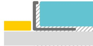
**Описание товара:** Перфорированный L-образный профиль для криволинейной отделки краев плитки. Рекомендуем применять станок гибочник.
