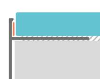
T-образный профиль для финишной отделки края террасы. Высота покрытия составляет 10 мм. Профиль используется в основном для окончания террас, которые не контактируют с водой. Обеспечивает идеальную окантовку, защищает края уступов от повреждений.
