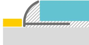
**Описание товара:** Перфорированный скругленный профиль для криволинейной отделки наружных углов, подходит для гибочника.
