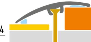
**Описание товара:** Анодированный алюминиевый или латунный профиль шириной 41 мм, имеет продольную жесткость. Применяется для соединения стыков между плиткой, ламинатом, паркетом, ковровых покрытий имеющими перепад от 0 мм до 13 мм. Самоклеющаяся основа повышенной прочности позволяет выполнить установку профиля в кратчайшие сроки без сверления.
