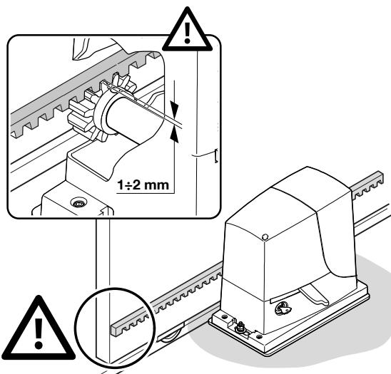
т - передвинуть вручную створку, используя шестерню, как контрольную точку для закрепления других элементов зубчатой рейки
