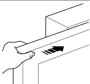
i - установить на шестерню электропривод первую часть зубчатой рейки: проверить, чтобы она совпадала с началом створки и что между шестерней и зубчатой рейкой обеспечивается расстояние 1÷2 мм (во избежание воздействия веса створки на электропривод)
