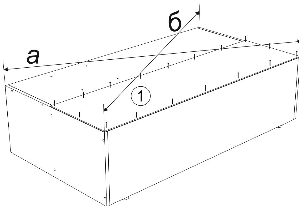
4. Прибейте к деталям №2 и №3 пластиковые подпятники, затем с помощью уголков 20x20 и шурупов 4x16 закрепите между собой цоколи, проверьте и уровняйте диагонали собранной конструкции как показано на схеме 3.
