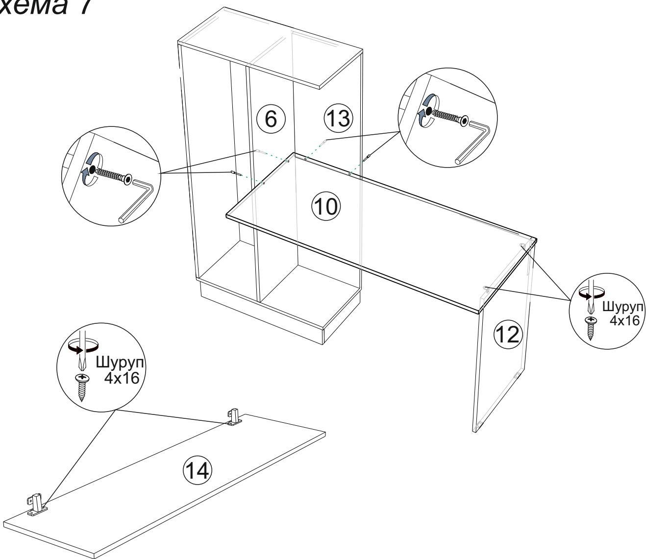
9. Закрепите створку №14 в ответные планки петель на боковине, зафиксируйте винты отрегулируйте и выставьте зазоры согласно схеме. Закрепите ручку с помощью шурупов 3,5x30. Установите полки №11 как показано на схеме 8.
