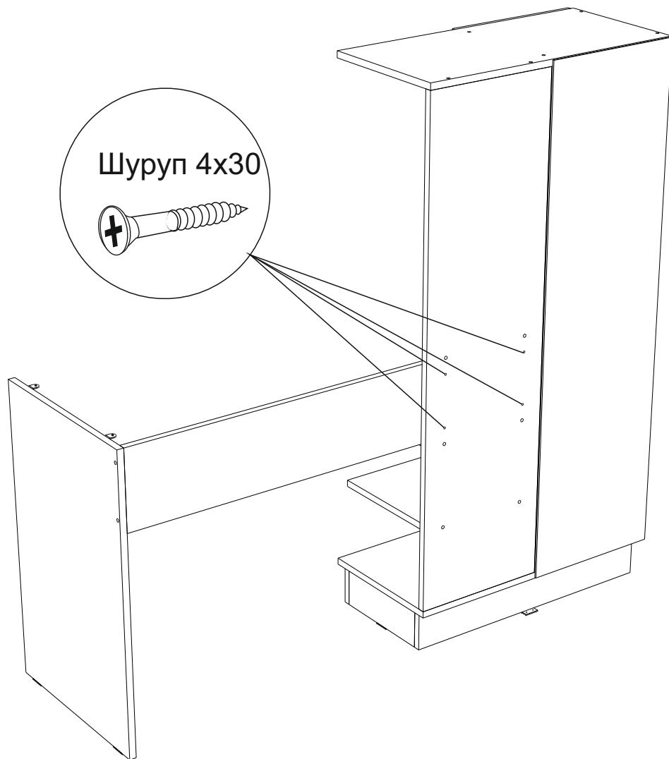
8. Закрепите крышку №10 к боковине №6 и к задней стенке №13 с помощью евровинтов, затем закрепите к боковине №12 с помощью шурупов 4x16 через уголки 20x20. Закрепите к створке №14 петли с помощью шурупов 4x16.
