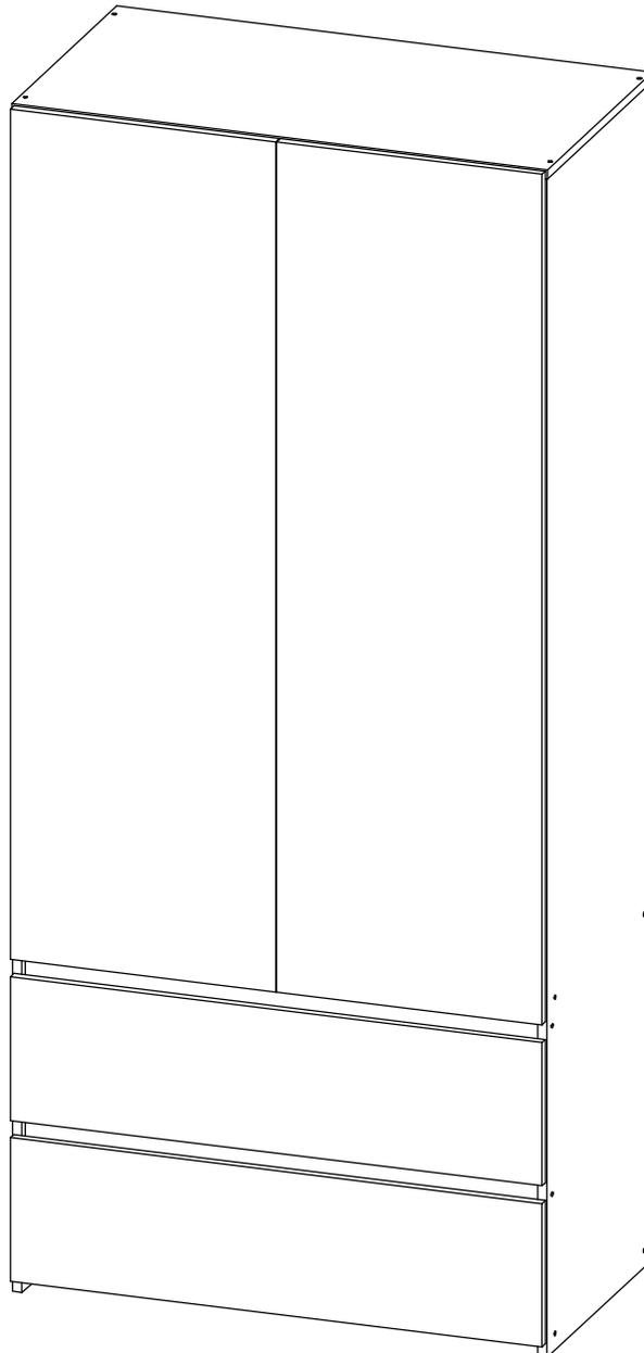
Максимальная нагрузка на шариковые направляющие до 10 кг (при равномерно распределённой нагрузке). Шкаф **ОБЯЗАТЕЛЬНО** крепить к стене.
