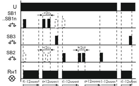
Однократное нажатие на выключатель SB1...SB1n включает реле в режим таймера с обратным отсчетом времени выключения нагрузки, двойное нажатие на выключатель в течение не более 2-х секунд включит реле в режим работы без таймера времени выключения, нагрузка будет включена постоянно до очередного нажатия выключателя
