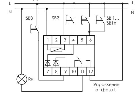
SB1...SBn – кнопочный выключатель управления «Включение-Отключение» нагрузки;
