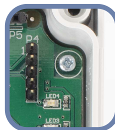
Рис. 10 Перемычка сброса регистров Modbus
