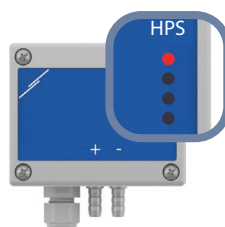
Рис. 10 Ошибка элемента датчика
