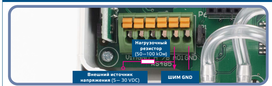
Рис. 6 ШИМ (открытый коллектор) подключение
