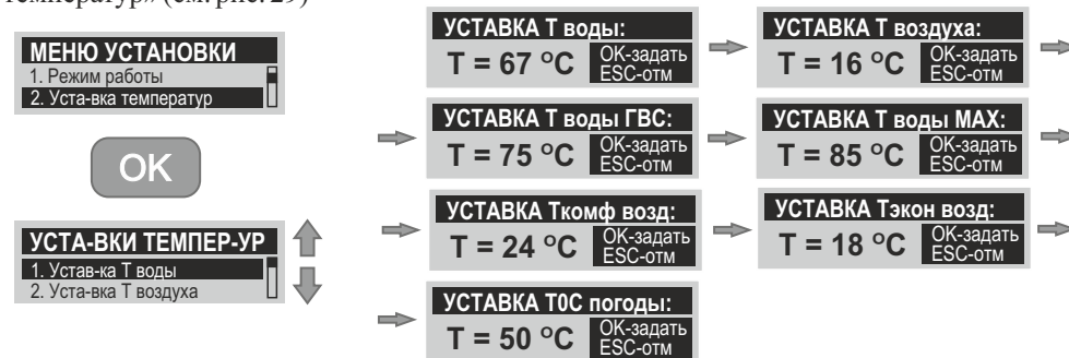
Рисунок 29. Установка температурных параметров.
