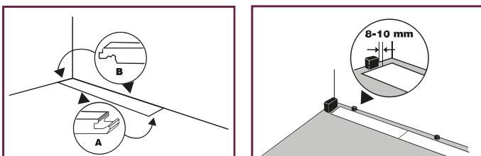
Собирайте ряд, соединяя половицы по поперечной стороне друг с другом, следующим образом: к первой и каждой последующей уложенной половице прикладывайте новую, под углом вводя ее гребнем в паз уже уложенного элемента. Затем опускайте укладываемую половицу до тех пор, пока она полностью не ляжет на пол.
