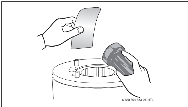
Рис. 56 Проверка наличия грязи в теплообменнике
