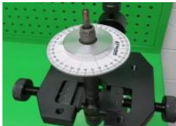
DL-CRN50107 Угломер для форсунок с диаметром гайки распылителя 17мм Диапазон углов: 0° - 360°.
