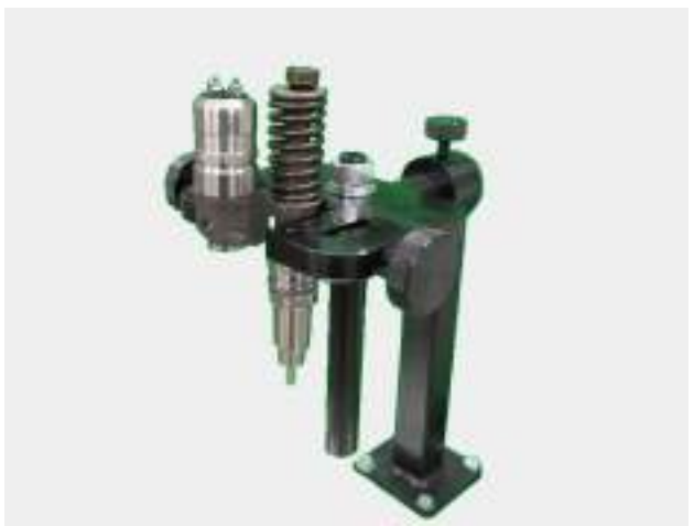
Установка в струбине насос-форсунки SCANIA Ч-образной
