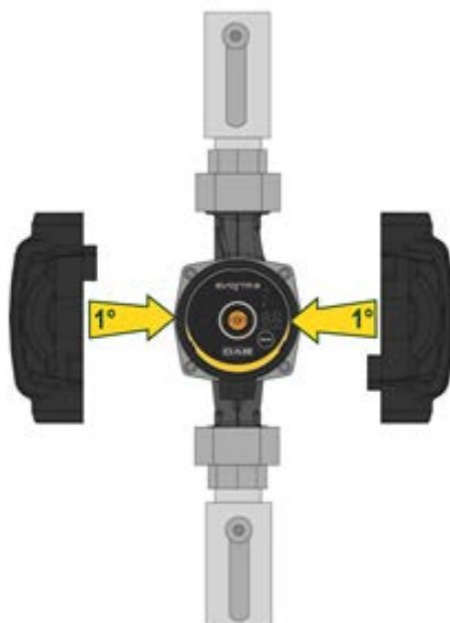
Figura 7: Izolare corp pompa
