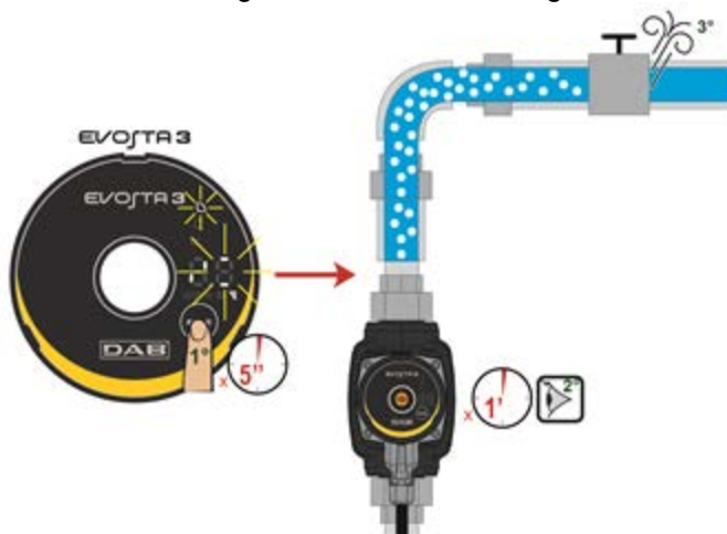
Fig 9: Automatisk avluftning av pumpen
