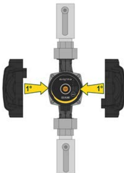
Rysunek 7: Izolacja korpusu pompy
