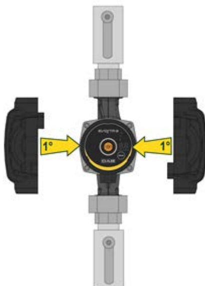
Fig 7: Isolering av pumphuset
