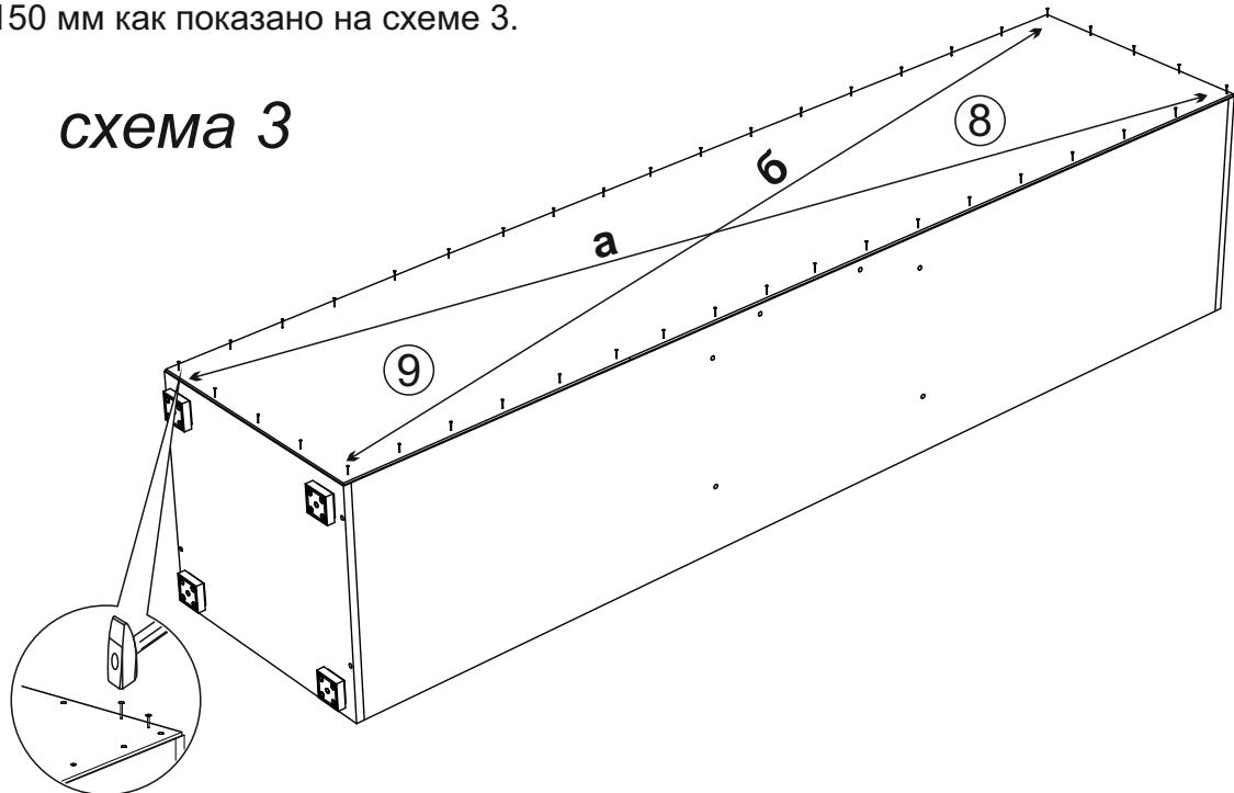
5. Установите шкаф на место. Закрепите петли на створках. Створки №7 прикрепите к боку №5 справа или слева в зависимости куда они должны открываться. Зазоры отрегулируйте по схеме приведенной выше, установите полки №2, как показано на схеме 4.
