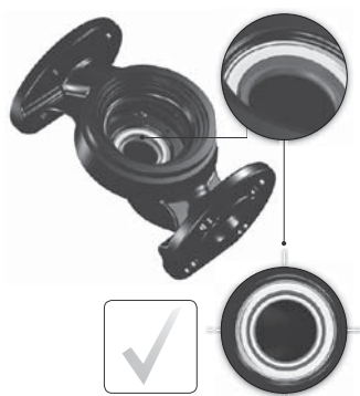
Рис. 16 Правильно выровненная система уплотнений
