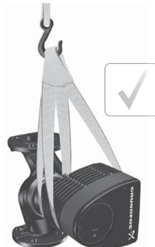
Рис. 9 Правильный способ строповки насоса
