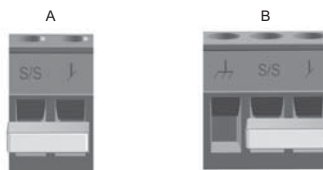
Рис. 33 Цифровой вход в блоке управления А. Исполнения с подключением электропитания через штекер В. Исполнения с подключением электропитания через клеммы
