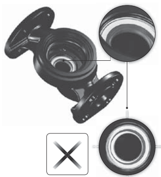
Рис. 17 Неправильно выровненная система уплотнений
