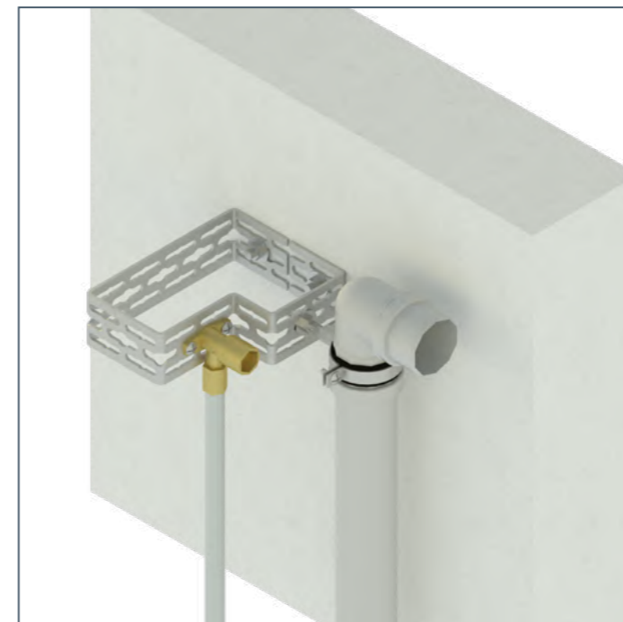
Дистанционный монтаж водорозеток
