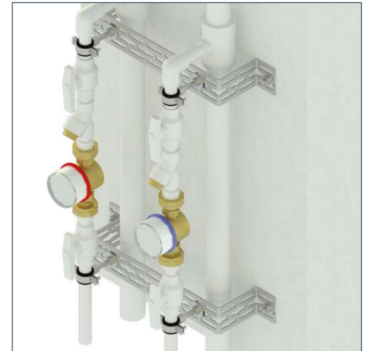
Надежное крепление обвязок при любом положении относительно несущего основания
