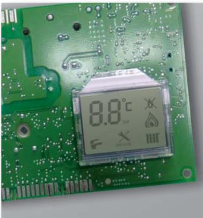
Электронная плата HONEYWELL с микропроцессором
