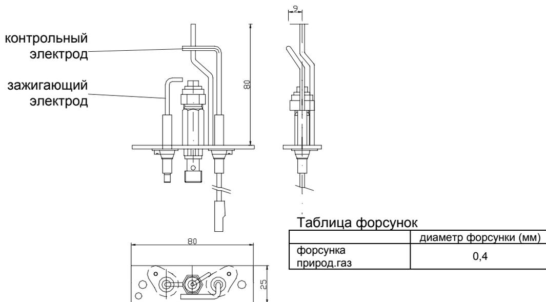
**Рис. 4б) Зажигающая горелка Furigas**
