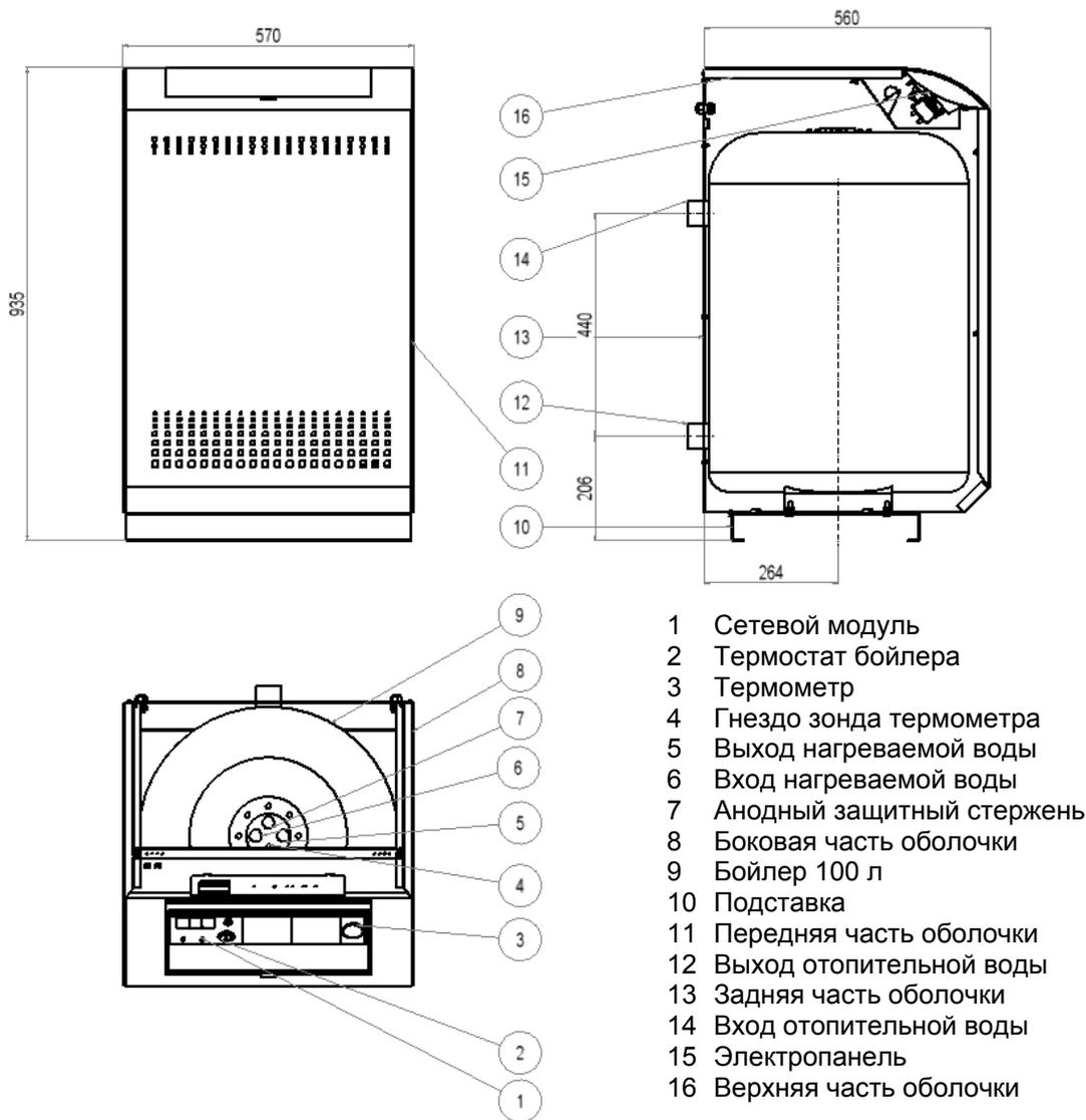
Рис. 12 Схема бойлера VIADRUS OV 100 L (в мм)
