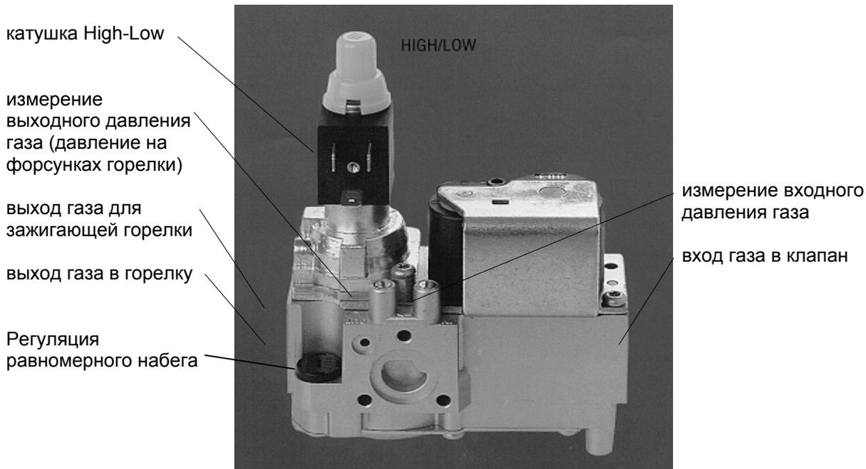
Рис. 25a) Газовый клапан Honeywell VK 4100 Q 2003
