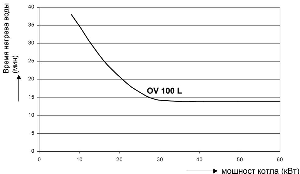
\*\*) Расход воды дан при темпер. отоп. воды 85 °С темп. перепада теплой техн. воды 35 °С (входн. темпер. ТТВ 10 °С, выходная темпер. ТТВ 45 °С). Если для бойлера исполыз. котел с мощностью другой, чем 26,5 кВт, измен. расход воды при сохранении выше указанных входных условий:
