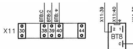
Рис. 18 Присоединение термостата насоса – поставка по желанию
