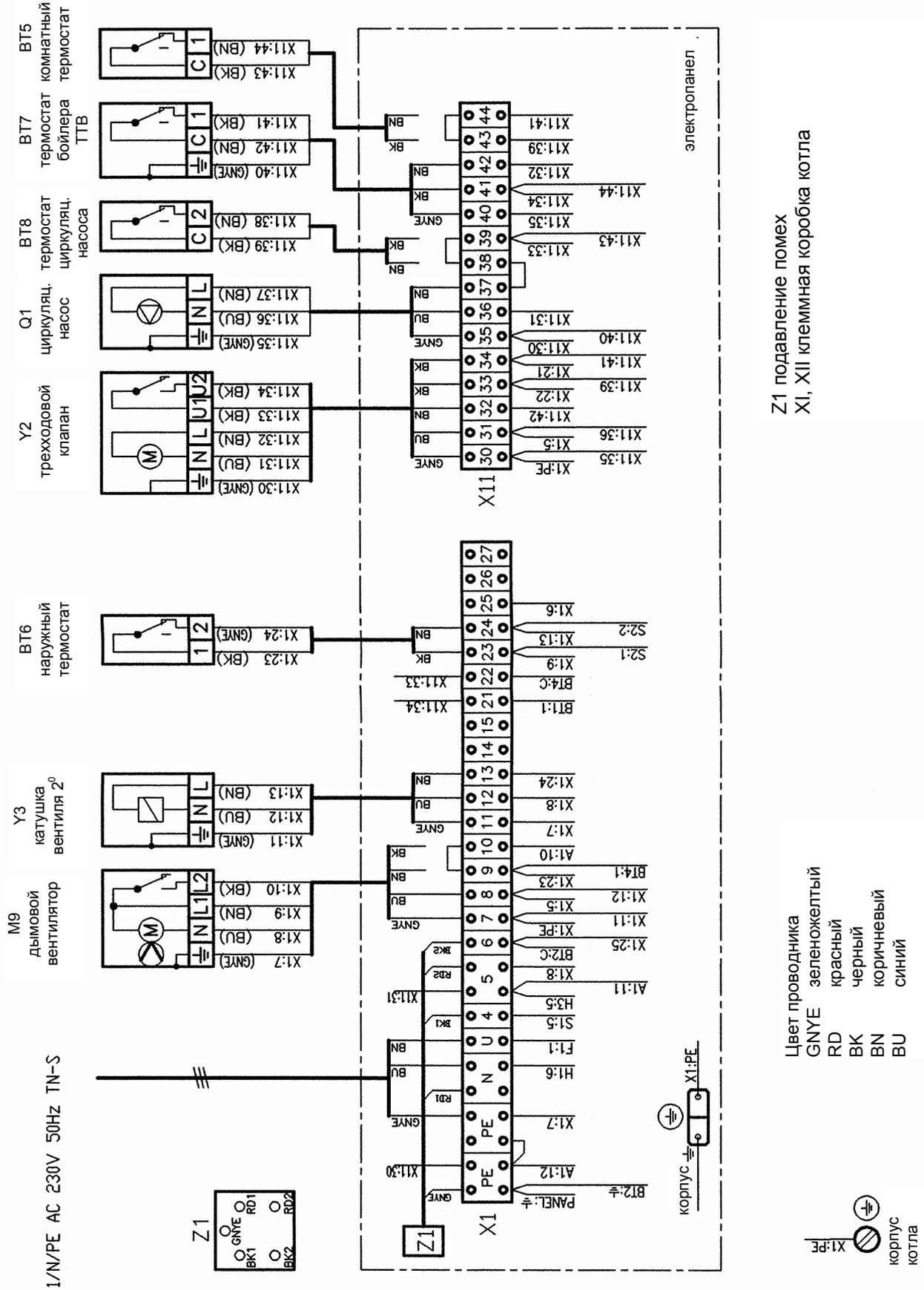
Рис.. 7б)/1 Схема включения котла VIADRUS GARDE G 42 и VIADRUS GARDE G 42 ECO для версии ПГ 2° с автоматикой Honeywell
