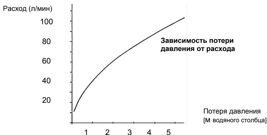
Рис. 14 Характеристика трехходового клапана Honeywell V 4044F
