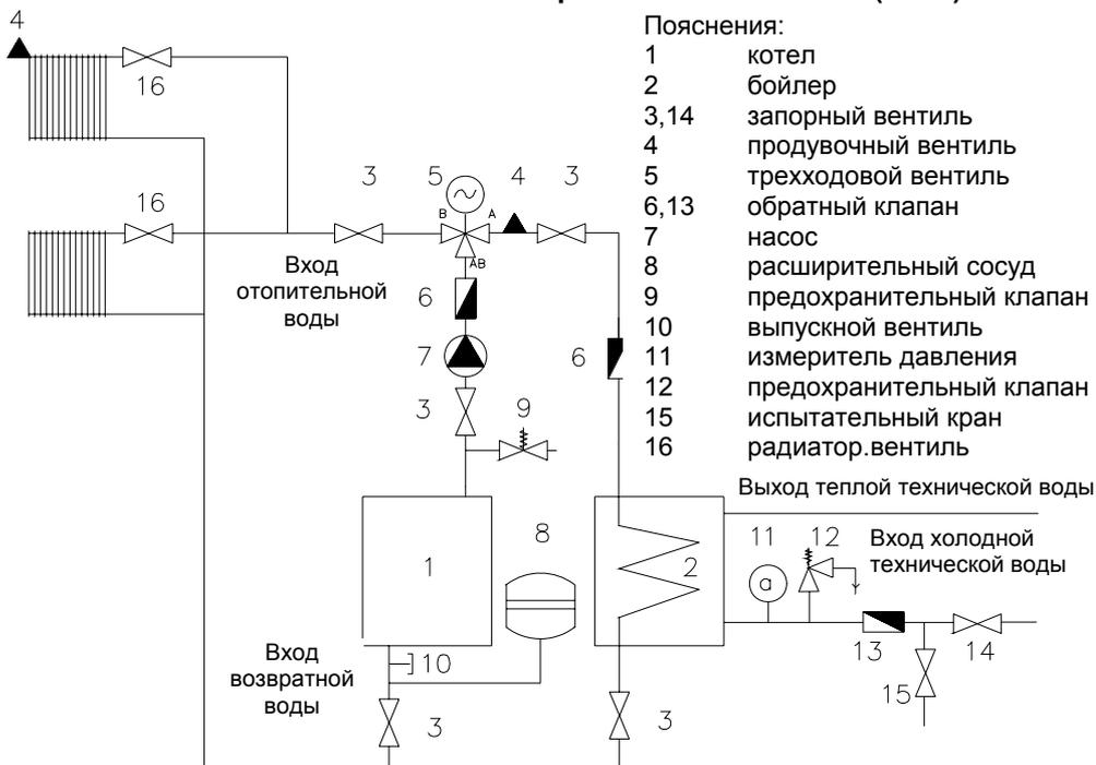
Примечание: Можно использовать комбинированную арматуру, состоящую из предохранительного и обратного клапана.
