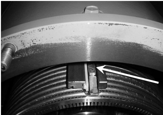
Abb.13-10 Einbauposition des Siebes, eingeschlagenes Dreieck oben und nach vorn zum Separator
