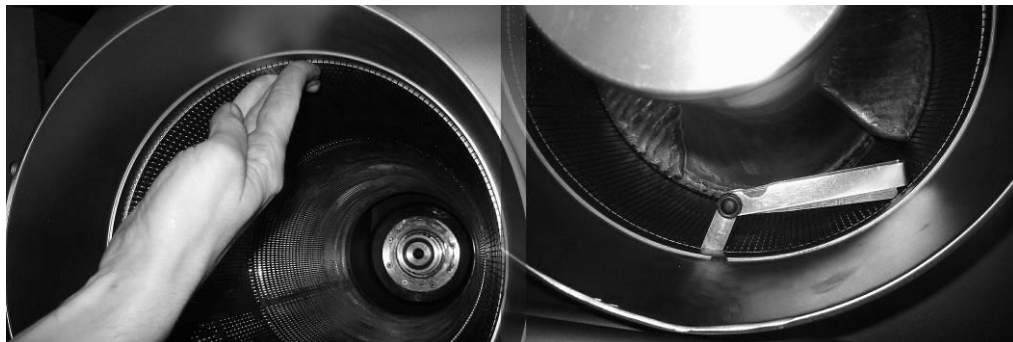
Abb.13-11: Bewegliches Sieb im Separator, Prüfung der Schwimmfähigkeit mit der Hand (links)
