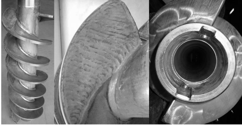
Abb.13-12: Schnecke mit gepanzertem Spezialwerkstoff und Nabenaufnahme, Neuzustand
