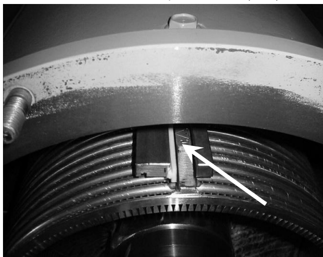
Рис. 4.7: Положение при установке сита, отштампованный треугольник сверху и по направлению к сепаратору
