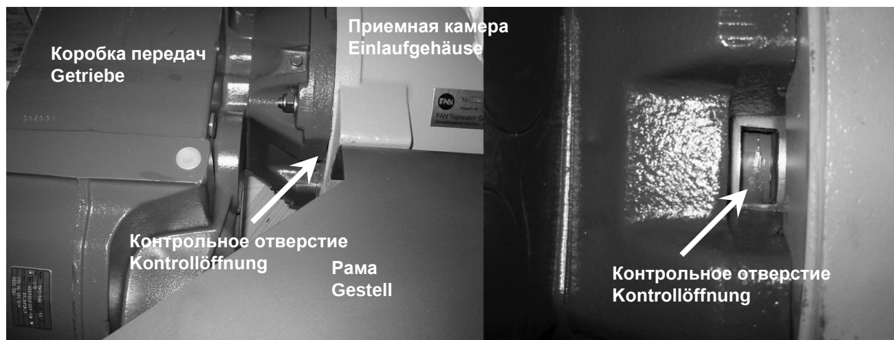
Рис. 5.1: Осмотр контрольного отверстия, чтобы убедиться в исправности уплотнителя Abb. 5.1: Begutachtung der Kontrollöffnung zur Sicherung der Funktionstüchtigkeit der Sperrdichtung
