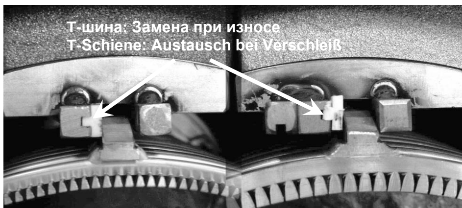
Рис. 4.2: Пластиковая профильная шина в направляющей шине сепаратора
