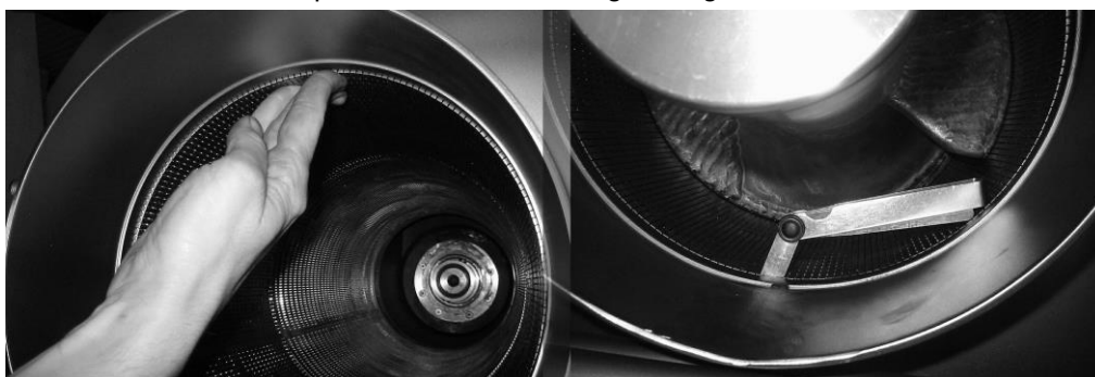
Abb. 4.7: Einbauposition des Siebes, eingeschlagenes Dreieck oben und nach vorn zum PSS
