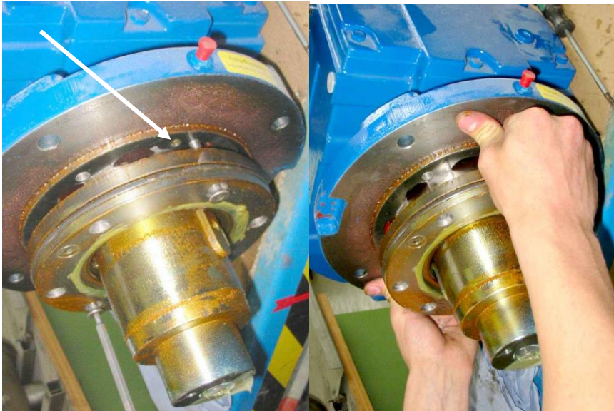
Рис. / Bild 5.3.1 Белая стрелка = Канал для смазки Weißer Pfeil = Fettkanal Рис. / Bild 5.3.2 После выдавливания длинными болтами в резьбовые отверстия для защитной крышки выньте держатель сальника Nach dem Auspressen mit den langen Schrauben in den Gewindebohrungen für die Abdeckplatte Dichtringträger herausziehen
