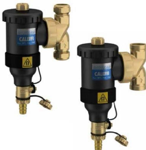
Дешламатор отделяет шлам, циркулирующий в закрытых контурах систем, шлам, прежде всего, состоящий из частиц песка и грязи, создавая очень низкое гидравлическое сопротивление. Шлам скапливается в объемной отстойной камере, которая позволяет производить её чистку с более низкой частотой, и из которой его можно сливать даже при работающей системе.
