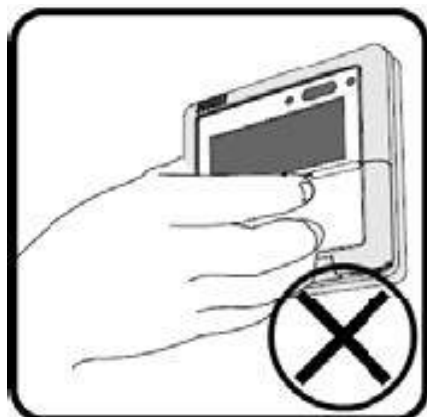
Демонтаж с левой стороны
