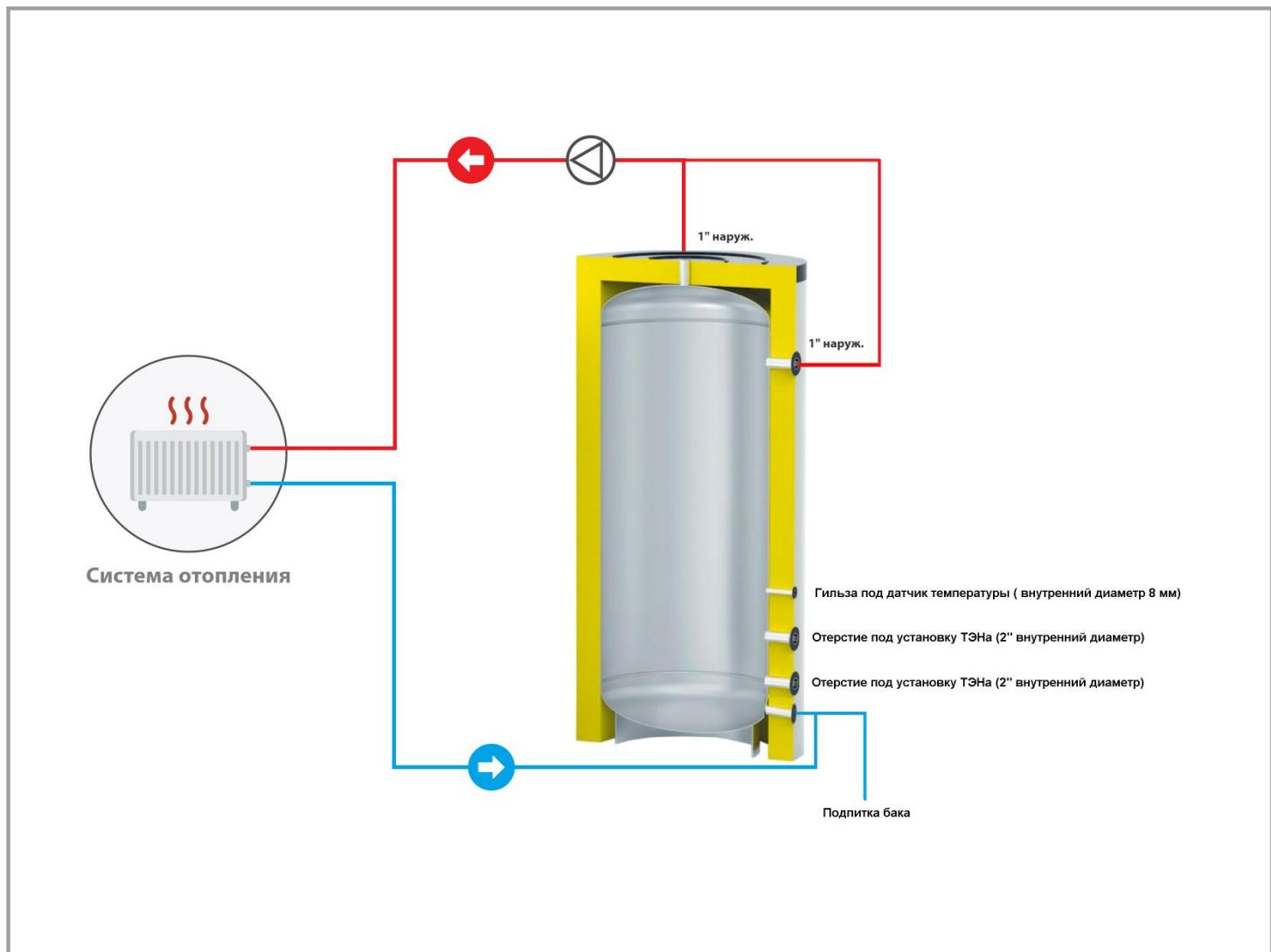
Область применения: - Аккумулирование нагретой технической воды.
