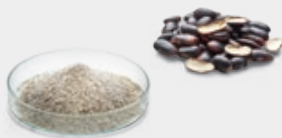
Гомогенная проба: фасоль до и после измельчения на скоростной роторной мельнице FRITSCHE PULVERISETTE 14
