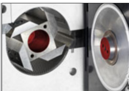
Особенно стабильная: ротор расположен на двойных подшипниках на валу и на дверце.
