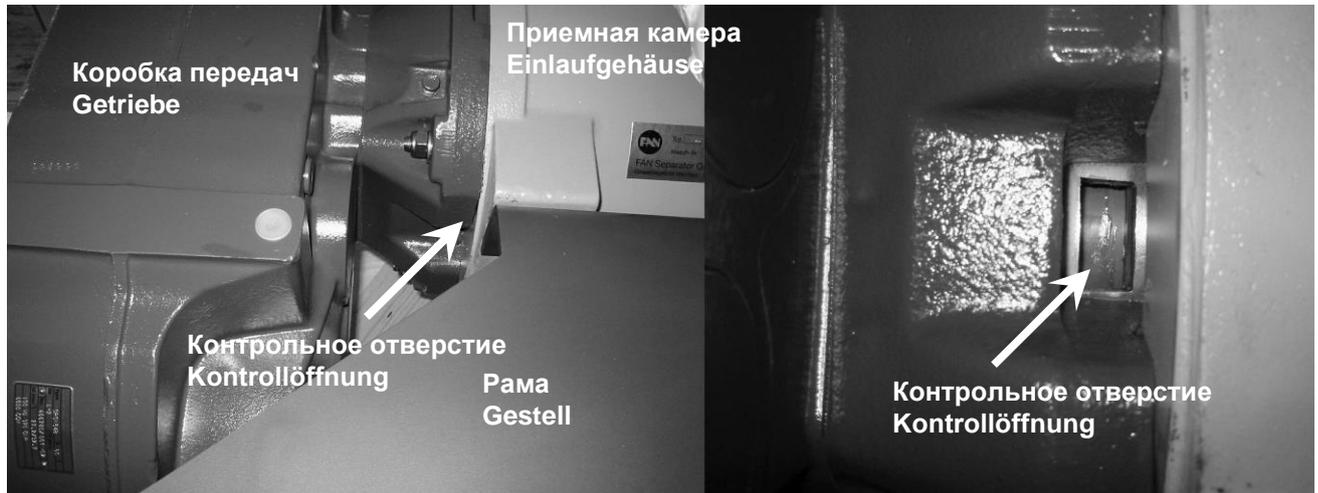
Рис. 5.1: Осмотр контрольного отверстия, чтобы убедиться в исправности уплотнителя
