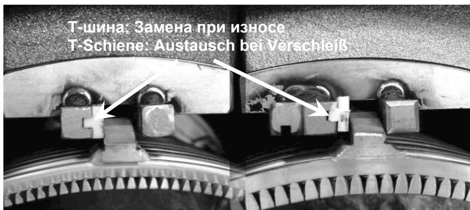
Рис. 4.2: Пластиковая профильная шина в направляющей шине сепаратора
