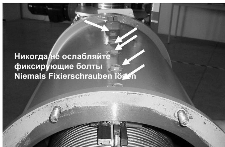
Рис. 4.5: Положение фиксирующих болтов для направляющих шин сита
