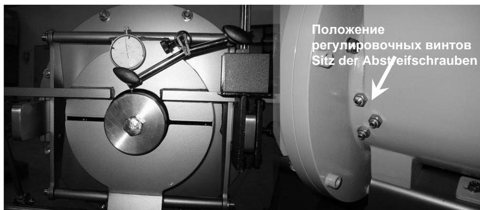
Рис. 4.11: Контроль раскачивающих ударов шнека (слева), регулировка регулировочных болтов (справа)
