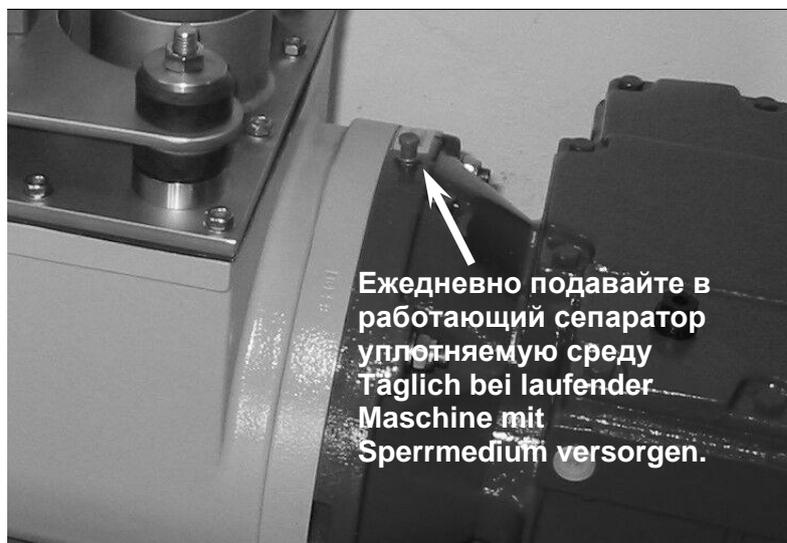
Рис. 4.1: Внесение уплотняемой среды
