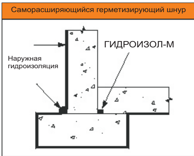
Рис.3 Монтаж шнура на сопряжении свайного оголовка и фундаментной плиты.
