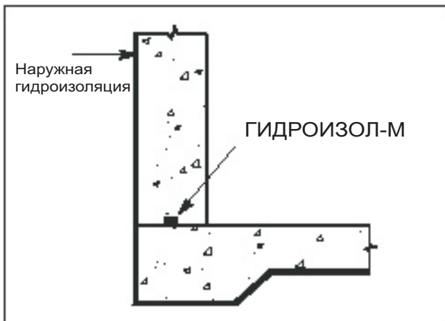
Рис.7 Монтаж шнура на стыках основания и фундаментной стены
