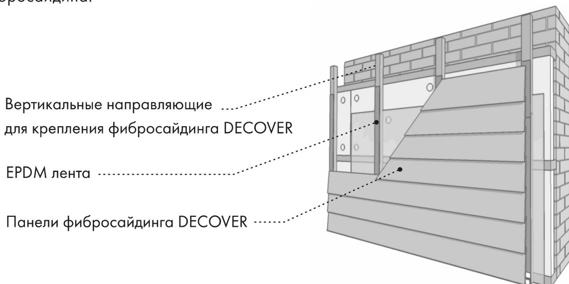
После монтажа направляющих необходимо смонтировать перфорированный профиль, чтобы предотвратить попадание насекомых, грызунов и мелких птиц в вентилируемое пространство.
