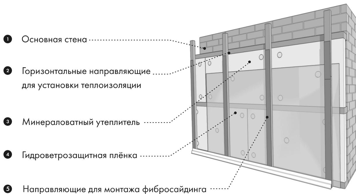
Толщина плит утеплителя определяется теплотехническим расчётом исходя из климатических условий, толщины и материала стены. При толщине утеплителя 100 мм и более монтаж производят в два слоя. Это делается для перекрытия стыков в слоях утеплителя во избежание появления мостиков холода.
