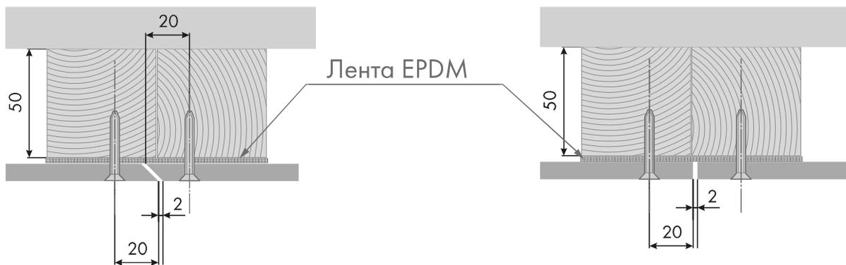
Оформление стыка панелей возможно двумя способами: с запилом торца под углом  $45^\circ$  или без запила. В каждом способе на местах стыка панелей используйте EPDM ленту. Зазор в 2 мм между панелями необходимо оставлять на каждые 20 м длины фасада. При длине фасада менее 20 м допускается монтаж без зазора.
