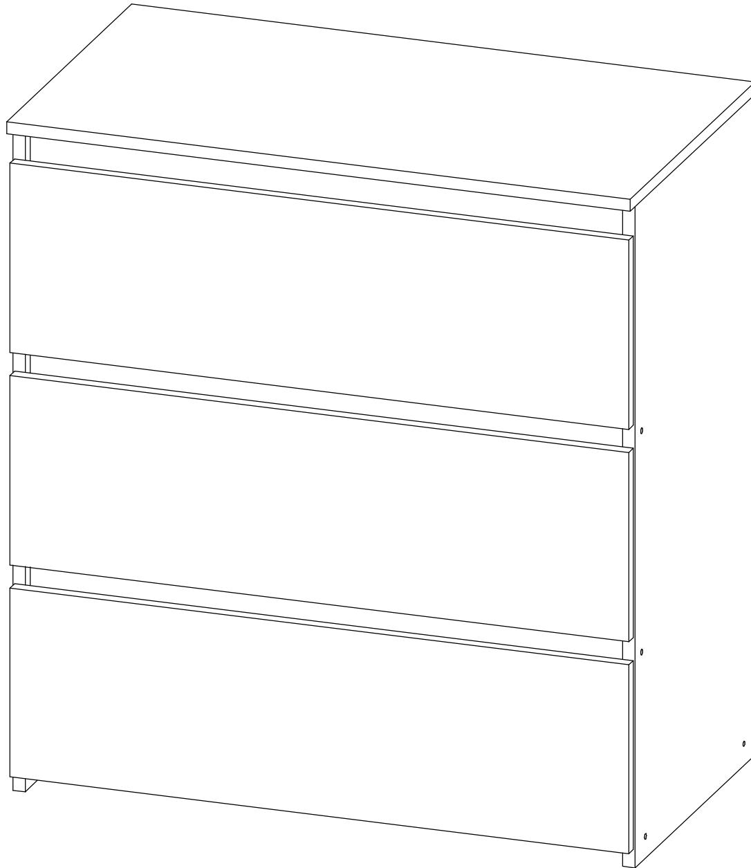
Максимальная нагрузка на шариковые направляющие до 10 кг (при равномерно распределённой нагрузке). Комод ОБЯЗАТЕЛЬНО крепить к стене.
