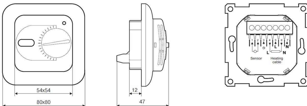
**Клеммы 1 и 2** присоедините половой датчик между соединителями;
