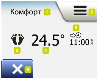
Во время работы термостата в режиме Комфорта на Исходном дисплее отображается кнопка “Х”. Нажмите эту кнопку для возврата термостата в автоматический режим работы по установленному графику.
