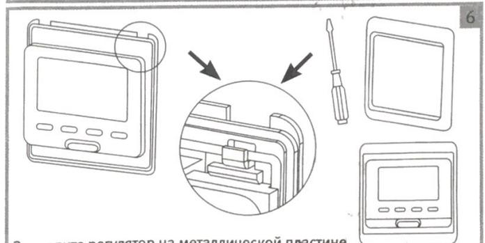
Закрепите регулятор на металлической пластине, закрепив его мет. зажимом и внешней рамкой
