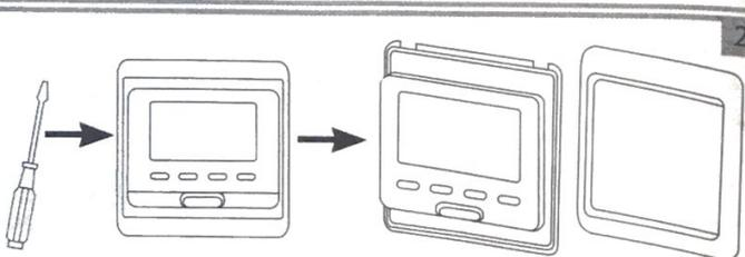
С помощью отвертки снимите внешнюю рамку регулятора
