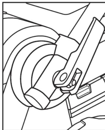
Прикрепите верхнюю стойку с рукояткой к нижней стойке с помощью шайбы и фиксатора с гайкой. Зафиксируйте кабель питания с помощью фиксатора кабеля питания, как показано на рисунке.
