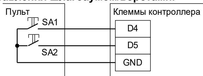
Рисунок 175. Пульт ручного управления шлагбаумом/воротами, кнопка «Стоп» нормально разомкнута.
