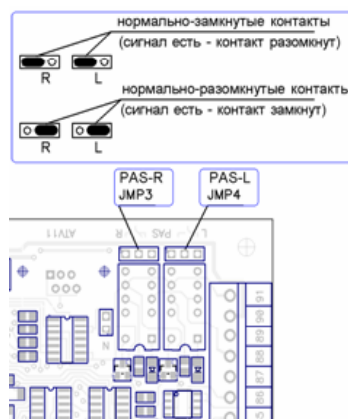
Рисунок 99. Перемычки JMP3 и JMP4 контроллера ОМА–DD.958, ОМА 264MC1, 866.MC2.
