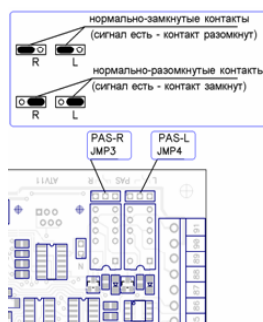
Рисунок 104. Перемычки JMP3 и JMP4 контроллера ОМА 264MC1.
