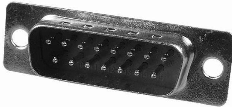
Рисунок 87. Штекер DB-15M, подключаемый к PERCo T-04.
