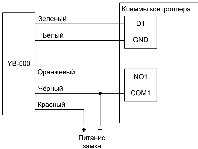
Рисунок 37. Пример подключения замка YB-500 для первой двери в конфигурации «Две двери».
